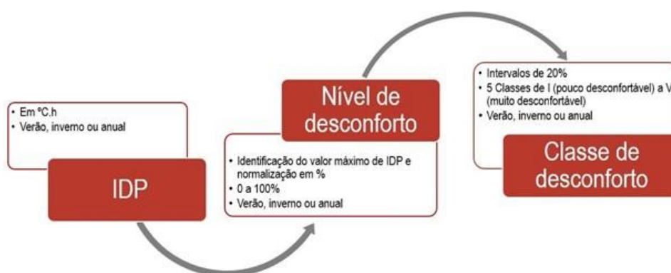
Figura 16 – Metodologia de determinação da classe de desconforto [90]
