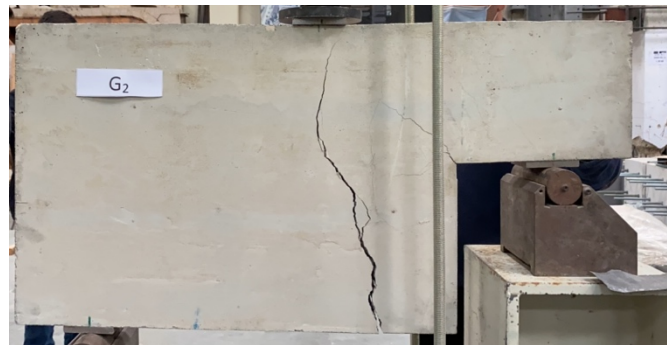
Figura 2.1 - Fissuração do betão
