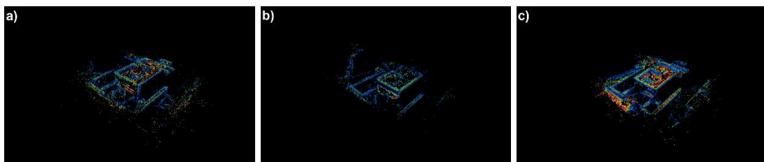
Figura 67 – Nuvem de pontos gerada para: a) céu limpo (C1); b) céu nublado (C2); c) vento forte (C3)
