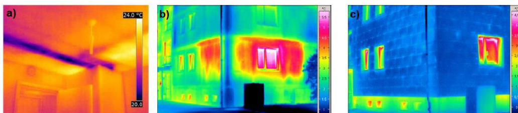
Figura 19 – Aplicação da termografia na: a) monitorização do impacto dos equipamentos de ar condicionado nas temperaturas superficiais; b) e c) avaliação do desempenho energético antes e após reabilitação, adaptado de [11, 26]
