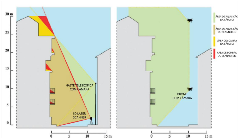
Figura 29 – Métodos de levantamento terrestre vs. levantamento com drone, adaptado de [36]
