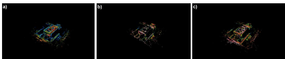
Figura 76 – Nuvem de pontos gerada para escala de temperatura fixa de: a) 5°C a 38°C (C25); b) 0°C a 24°C (C26); c) -10°C a 30°C (C27)
