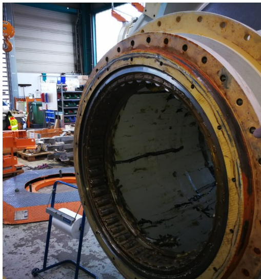
(a) Rolamento traseiro inserido no veio principal.
