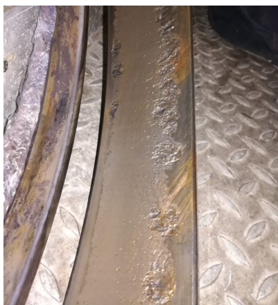
(a) Fadiga iniciada na superfície do anel externo.
