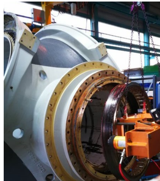
(b) Remoção do rolamento traseiro.
