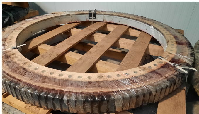
Figura 2.15: Rolamento de yaw do modelo E-70 E4: rolamento de esferas de dupla pista com coroa de orientação.
