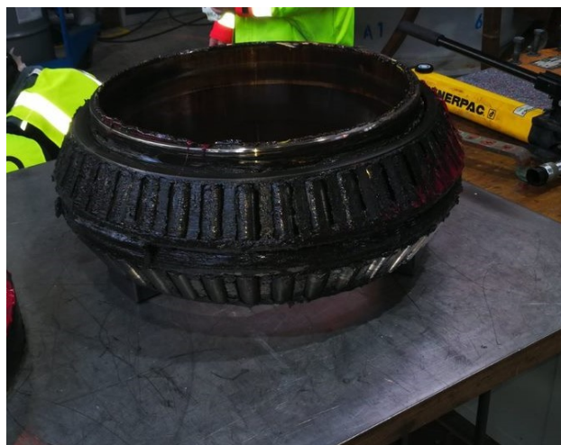
Figura 2.13: Rolamento frontal do modelo E-82 E2: rolamento de rolos cónicos de dupla pista. Autoria de imagem: Finerge
