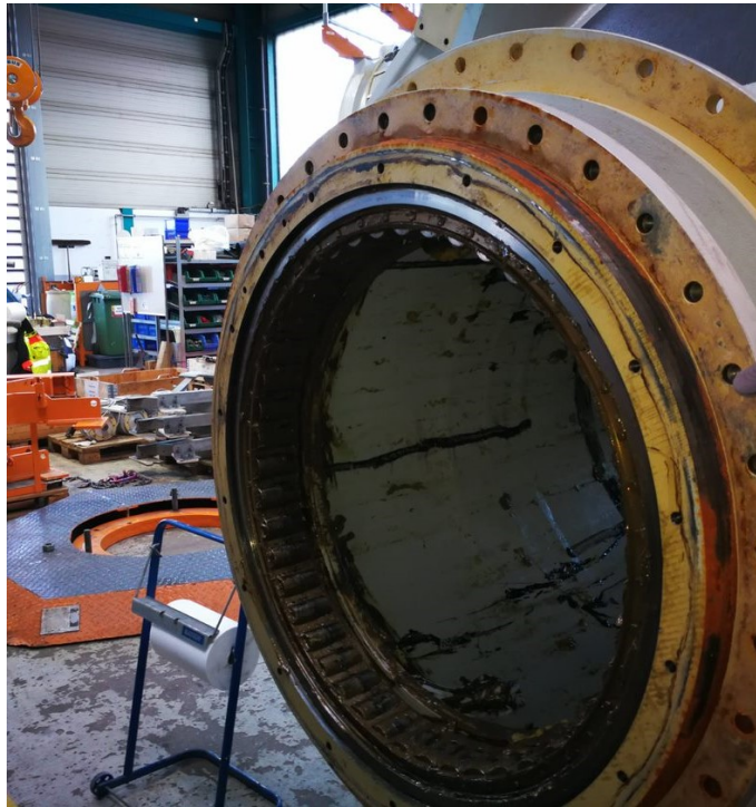
Figura 2.14: Rolamento traseiro do modelo E-82 E2: rolamento de rolos cilíndricos. Autoria de imagem: Finerge
