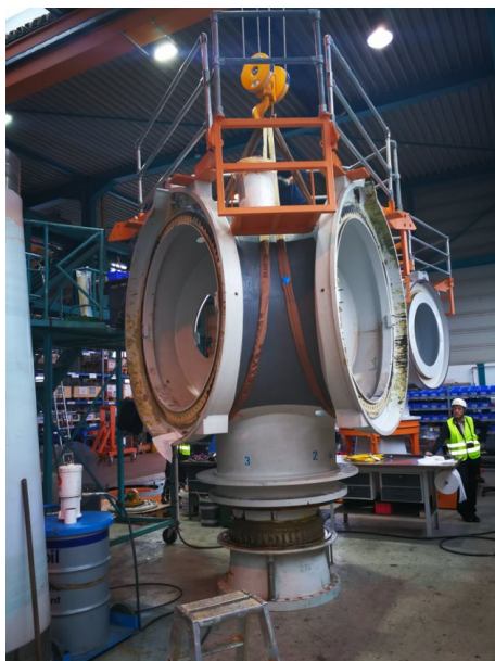
(a) Conjunto hub do rotor + veio principal.
