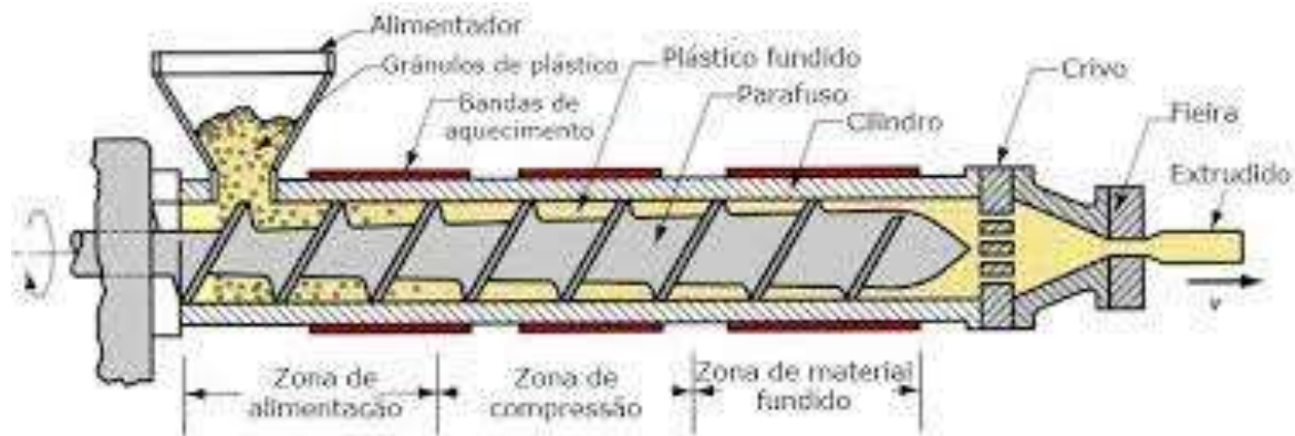
Figura 14-Esquema de uma extrusora
