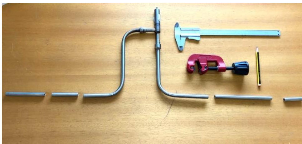
Figura 4.1 - Válvula de expansão cortada e ferramentas utilizadas para o efeito.
