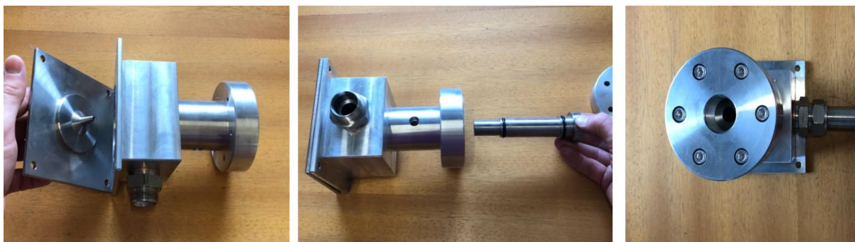
Figura 4.5 - Montagem do novo ejedor.
