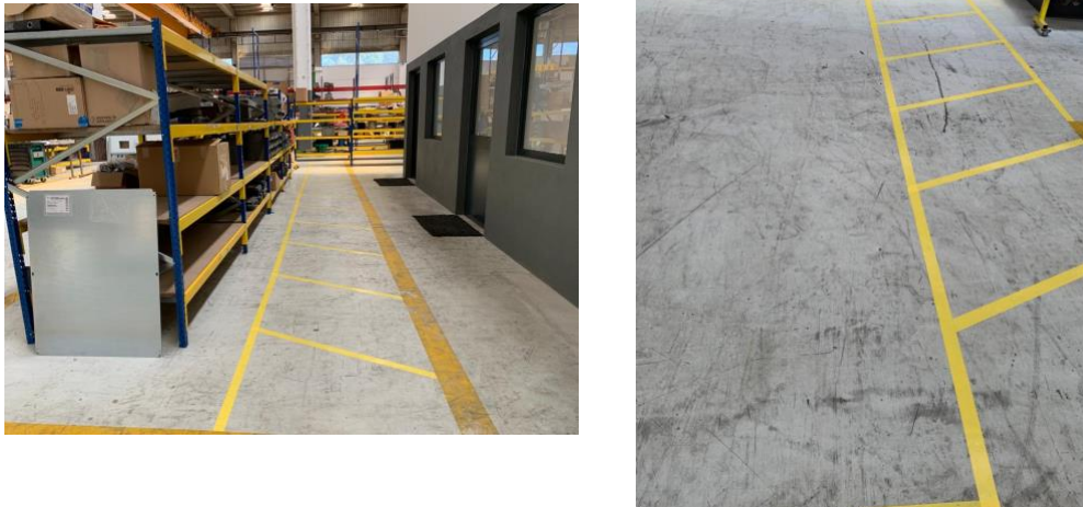
Figura 23 - Layout de chão de fábrica em fase de sinalização
