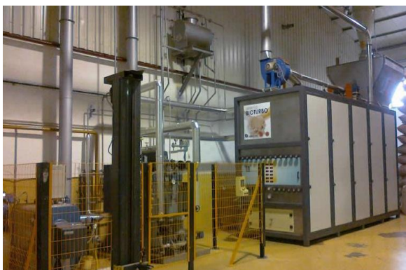
Figura 17. Sistema de esterilização de granulado de cortiça da Turbo-Nor [23]
