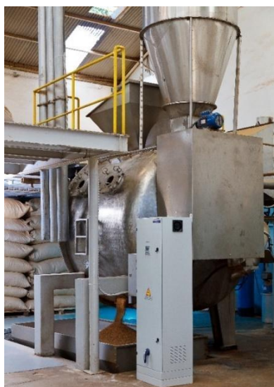
Figura 28. Sistema de esterilização do granulado de cortiça anteriormente implementado na GF Cork
