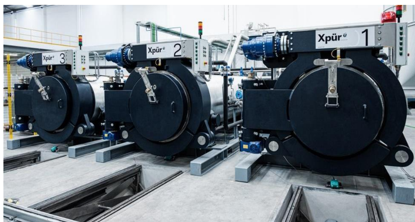
Figura 24. Sistema de tratamento de granulados de cortiça com CO 2 supercrítico - Xpur® [31]
