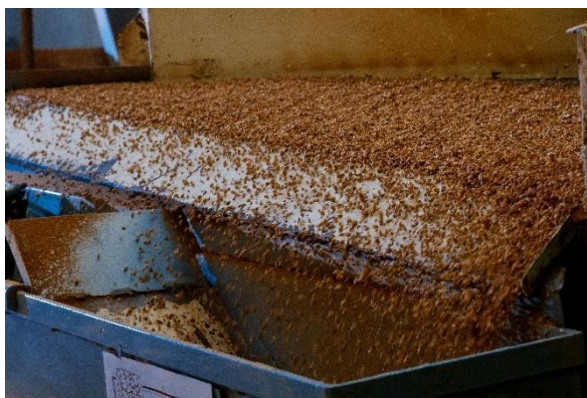
Figura 10. Separação do granulado de cortiça nas mesas densimétricas
