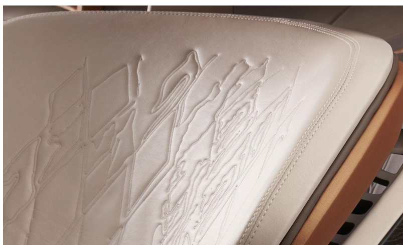
Figura A-13 - Assentos do automóvel-conceito EXP 100 GT da Bentley, utilizando o material VegeaTextile [60].
