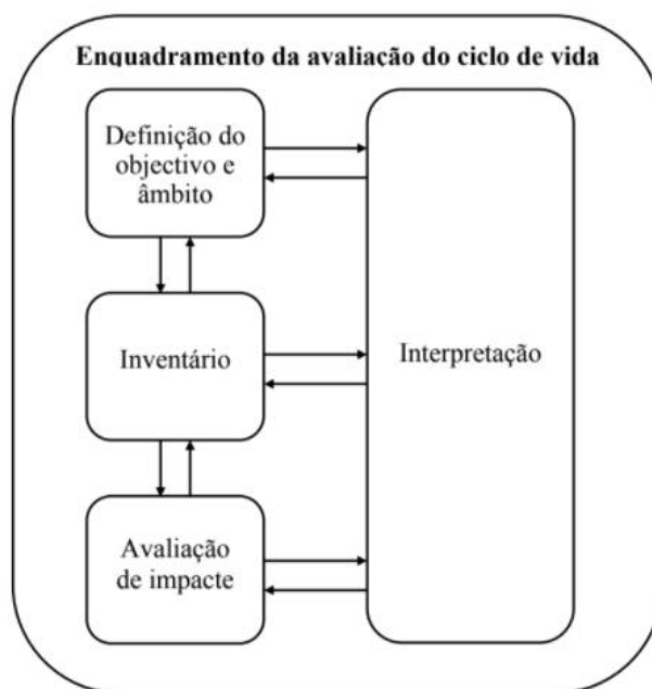
Figura 3-1 - Representação das quatro fases existentes num estudo de ACV [73].
