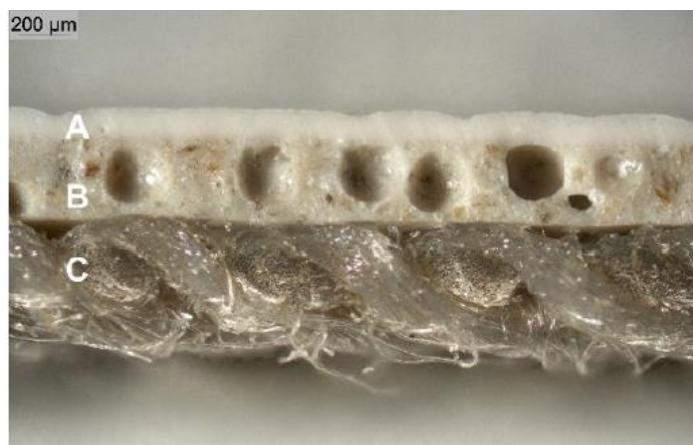
Figura A-7 - Esquematização das três camadas (A, B e C) constituintes do material Desserto, com uma espessura de 200 \mu\text{m} [43].
