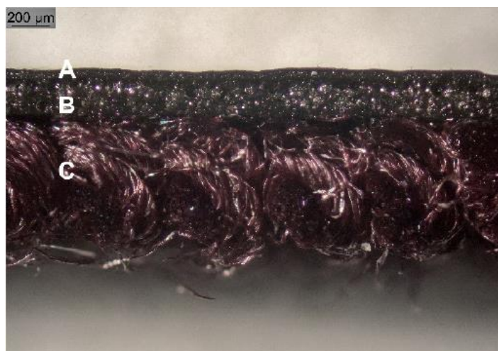
Figura A-10 - Esquematização das três camadas (A, B e C) constituintes do material VegeaTextile , com uma espessura de 200 µm [43].
