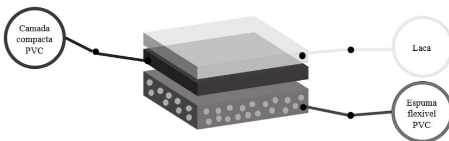
Figura 1-5- Representação por camadas do material PVC Expanded Foam Foil comercializado pela TMG Automotive.
