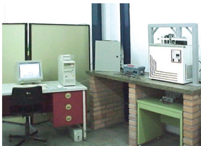
Fig. 4.14 - Ensaio de determinação do coeficiente de dilatação térmica linear [104].
