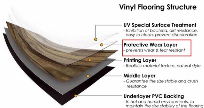
Fig. 4.10 - Composição de um pavimento vinílico [99].
