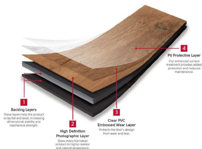
Fig. 3.13 - Estrutura de um pavimento vinílico [62].
