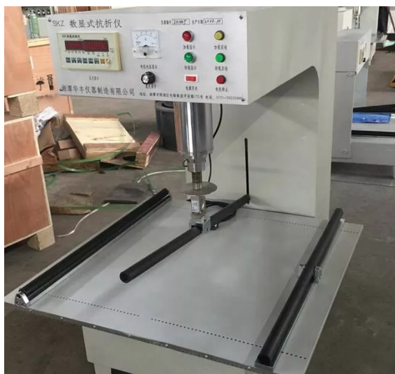
Fig. 4.13 - Máquina usada no ensaio para obter o módulo de rutura [103].
