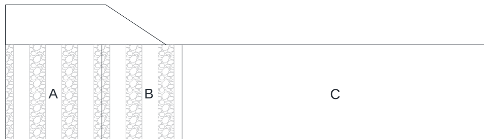
Figura 6-8 – Divisão da fundação em três zonas típicas
