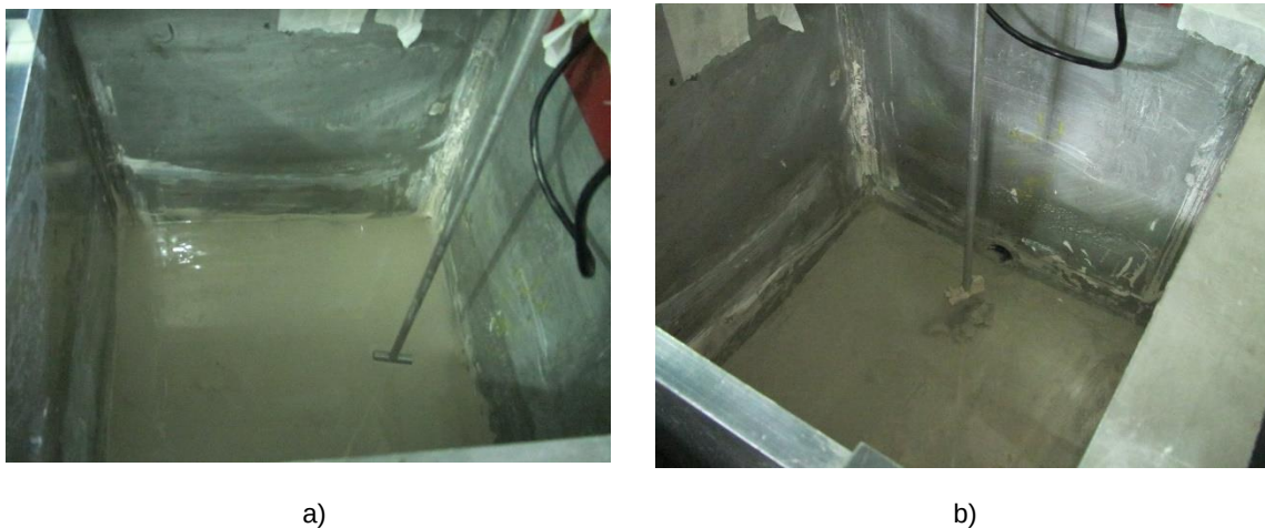
Figura 8-32 – Ensaio do penetrómetro barra-T: a) antes do ensaio; b) após o ensaio
