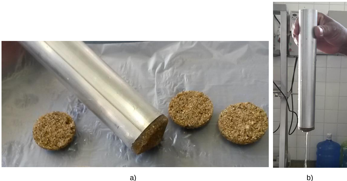
Figura 8-12 – Ponteiros drenantes: a) Tubo metálico com a ponteira drenante na extremidade; b) Teste de permeabilidade da ponteira
