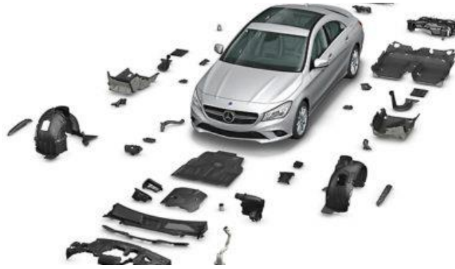
Figura 9 – Aplicações de termoplásticos de engenharia na indústria automóvel [9]
