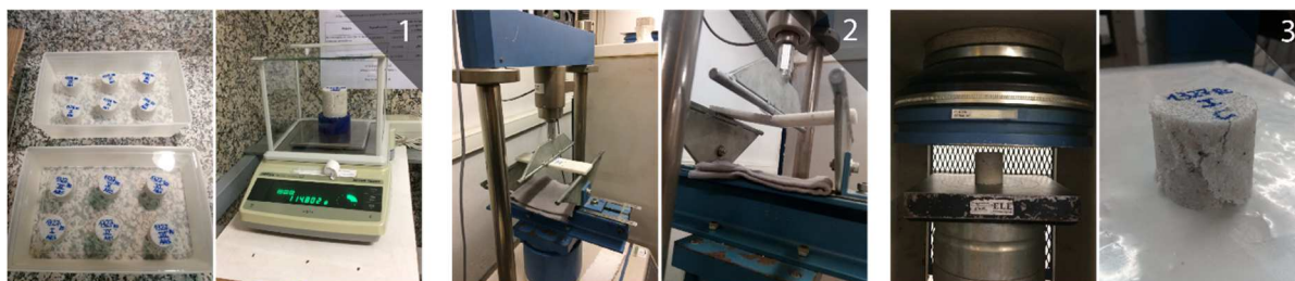
Figura 6: Ensaios realizados; (1) de absorção de água e massa volúmica aparente, (2) resistência à flexão, e (3) ensaio de compressão.
