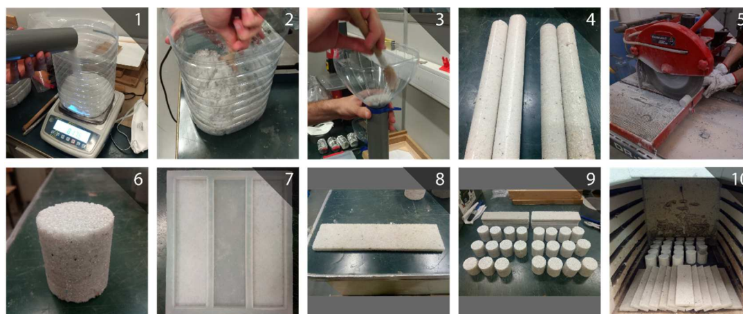
Figura 5: Fabrico dos provetes; (1-3) preparação da mistura e vazamento nos tubos de PVC, (4) obtenção dos varões compósitos cilíndricos, (5) corte dos provetes, (6) provete final, (7) fabrico de placas, (8) provete plano, (9) provetes cilíndricos, e (10) secagem em mufla a 55°C.
