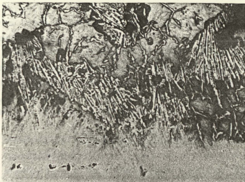
Fig. 89 - Soldadura em ferro fundido nodular ferrítico com eléctrodos de níquel-ferro. Observa-se a progressão dos carbonetos na ZAC, intergranularmente. Nital a 2%. (X 600)
