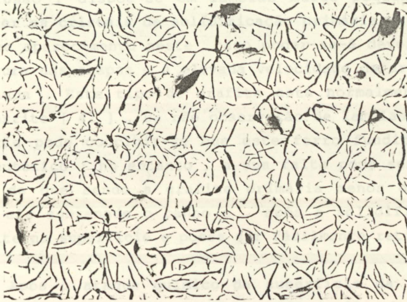
Fig. 41 - Lamelas de grafite eutética do tipo A, no ferro fundido cinzento. Sem ataque. (X112)
