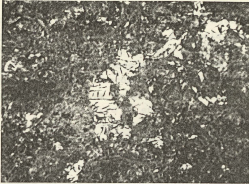
Fig. 107 - Soldadura do ferro fundido cinzento com eléctrodos de aço inox E 312-16 e pré-aquecimento. ZAC com perlite e alguma martensite (ao centro). Nital a 2%. (X 1800)
