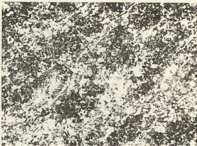
Fig. 78 - Soldadura em ferro fundido nodular ferrítico com eléctrodos de aço macio ESt e pré-aquecimento. Passe de retoma, com perlite e linhas de cementite. Nital a 2%. (X 300)
