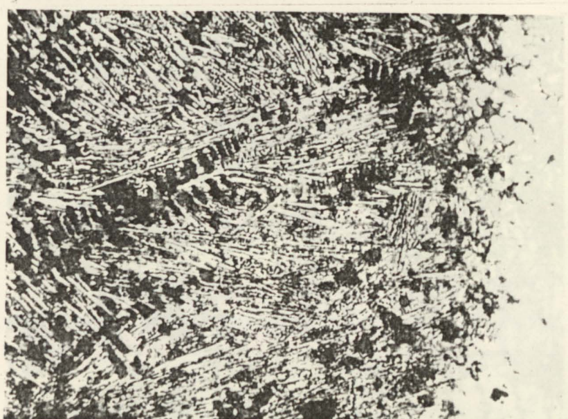
Fig. 110 - Soldadura do ferro fundido cinzento com eléctrodos de níquel. Tanto em a) como em b) é visível a existência de cementite e ledeburite na linha de fusão. Nital a 2%. (X 600)
