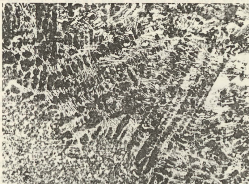
Fig. 75 - Soldadura em ferro fundido nodular ferrítico com eléctrodos de aço macio E 7018 e pré-aquecimento. Linha de fusão com carbonetos e ledeburite. Nital a 2%. (X 300)
