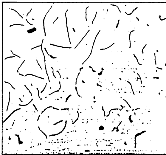
Fig. 1 - Forma da grafite nos ferros fundidos cinzentos. Sem ataque (x 250) [4].
