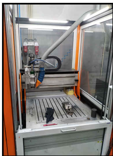
Figura 3.15: Fresadora CNC (esquerda) e máquina de eletroerosão (direita) utilizados para produção de marcas fogo.
