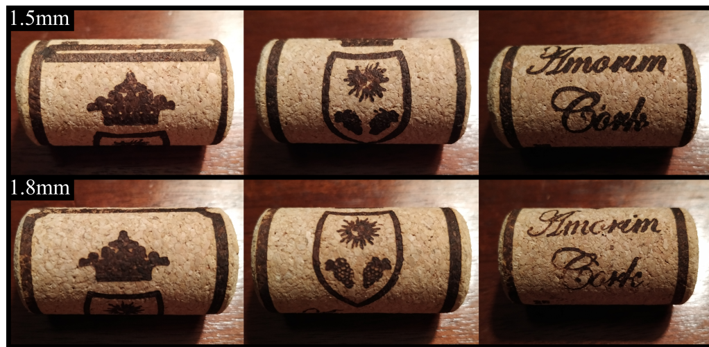
Figura 5.10: Teste de marcação em rolhas com altura da zona de marcação de 1.8 e 1.5[mm].
