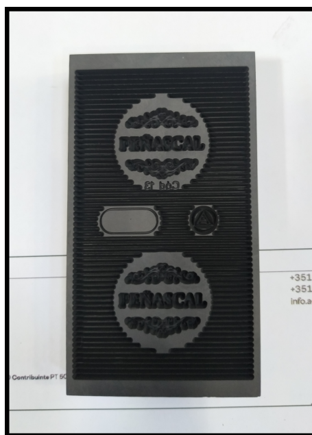
Figura 3.14: Exemplo de uma peça, em grafite, necessária ao processo de fabricação da marca (ferramenta para eletroerosão).
