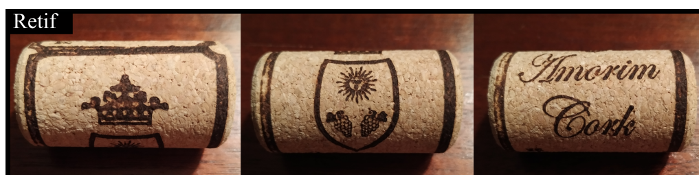
Figura 5.9: Teste de marcação em rolhas com marca retificada.
