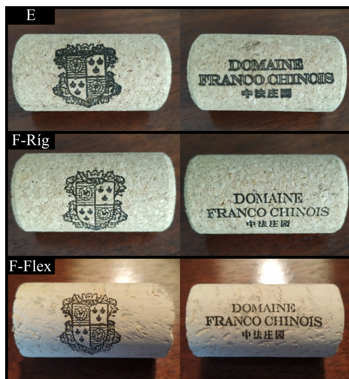
Figura 5.6: Rolhas carimbadas pelas marcas produzidas por cada empresa para a marcação a tinta.
