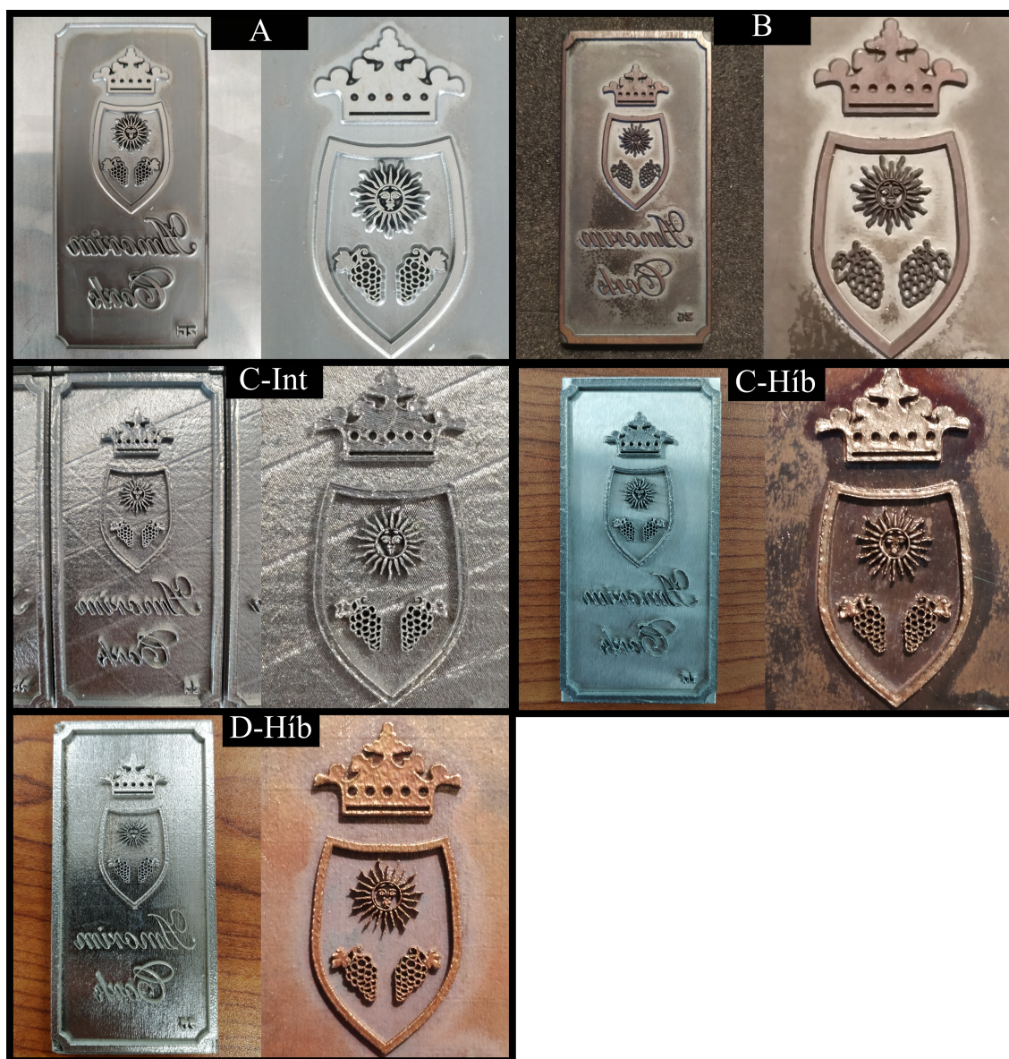
Figura 5.1: Carimbos para marcação a fogo produzidos pelas várias empresas, com destaque na zona mais detalhada.
