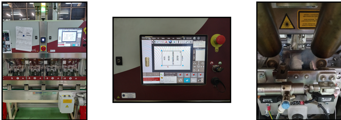
Figura 3.2: Equipamento utilizado para efetuar a marcação a laser (esquerda), painel de controlo digital (centro) e marcação de uma rolha (direita).
