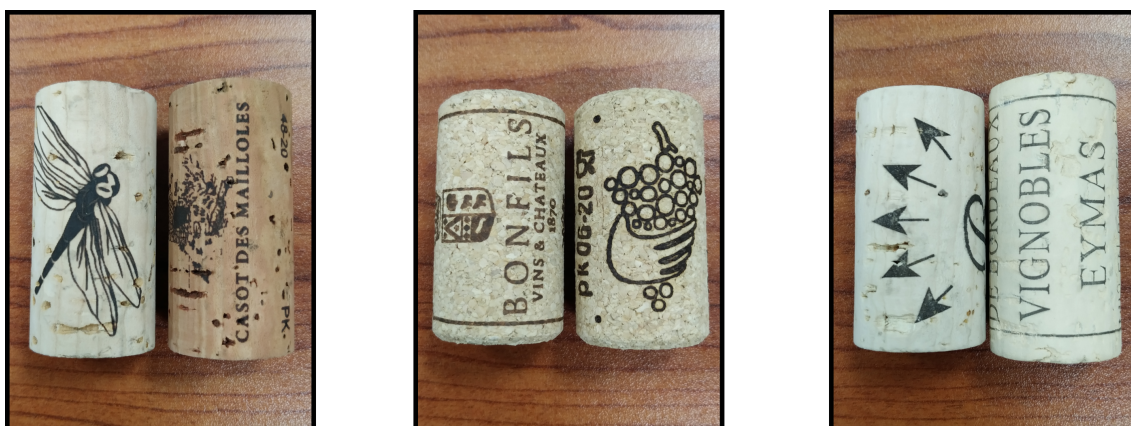
Figura 3.1: Os três tipos de marcação de rolhas, da esquerda para a direita: marcação a laser, marcação a fogo e marcação a tinta.
