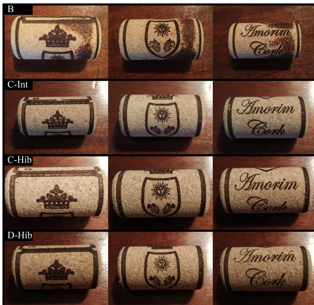
Figura 5.3: Rolhas carimbadas pelas marcas produzidas por cada empresa para a marcação a fogo.
