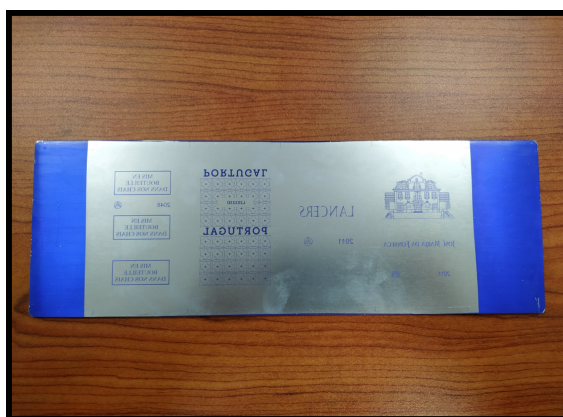
Figura 3.19: Aspetto final da placa quimicamente maquinada.
