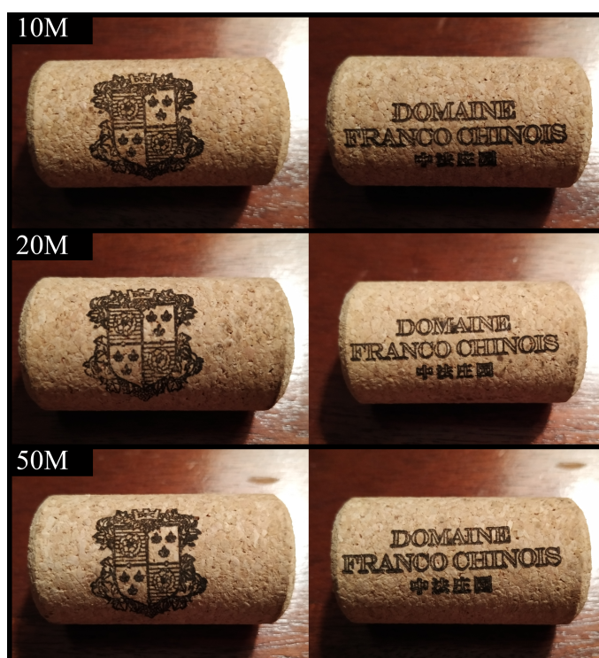
Figura 5.7: Teste de desgaste de marca fabricada pelo processo flexográfico com exemplares de rolhas próximas das 10000, 20000 e 50000 marcações.
