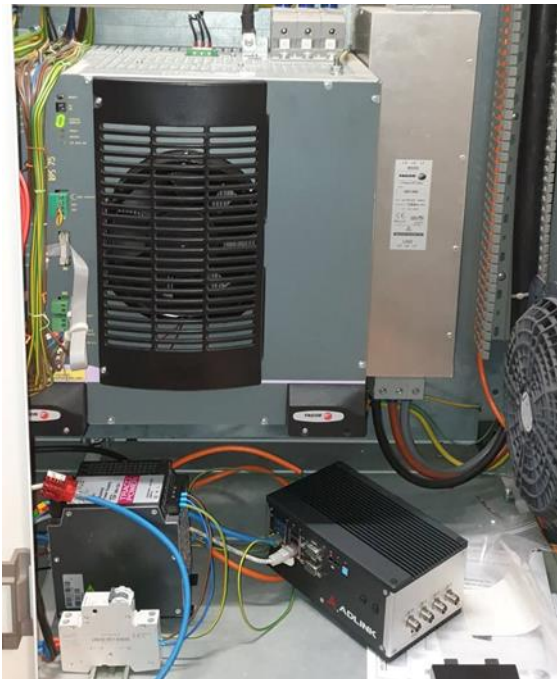
Figura 6.1 - Ligações entre o Edge Computer e a Fonte de Tensão e integração no armário da máquina.
