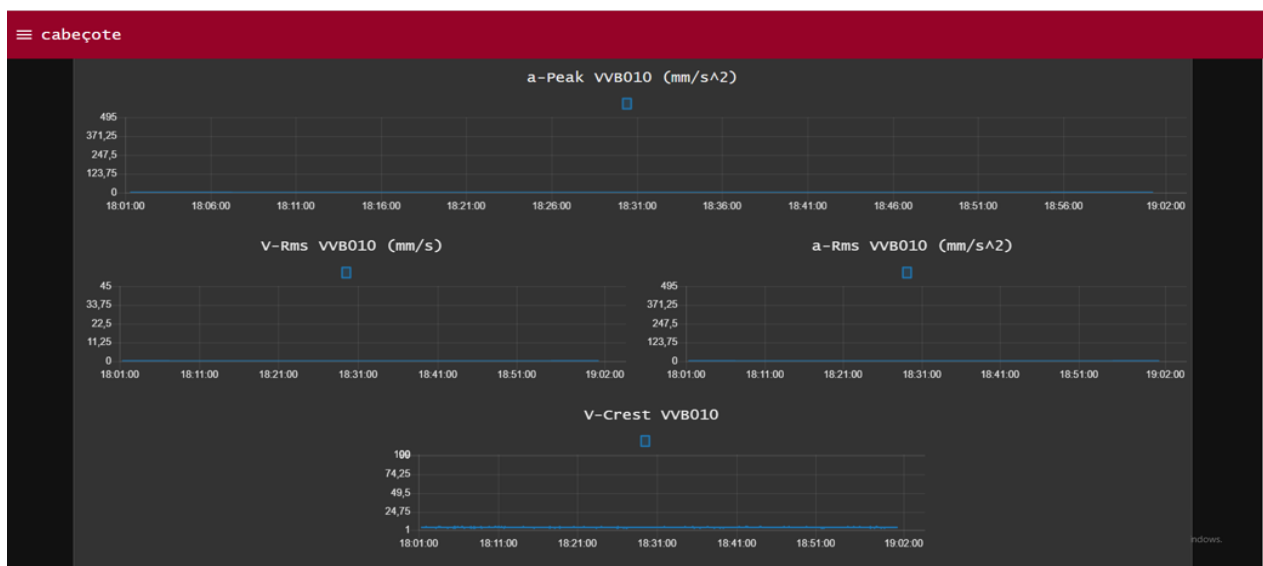
Figura 5.17 - Visualização da monitorização dos sensores instrumentados no corpo do cabeçote.
