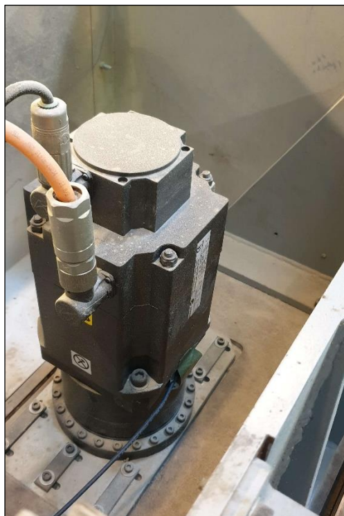
Figura 3.42 - Implementação do sensor de temperatura TS2229 e do sensor de vibração VSA005 fixados no corpo do motor Mx, na direção axial X.
