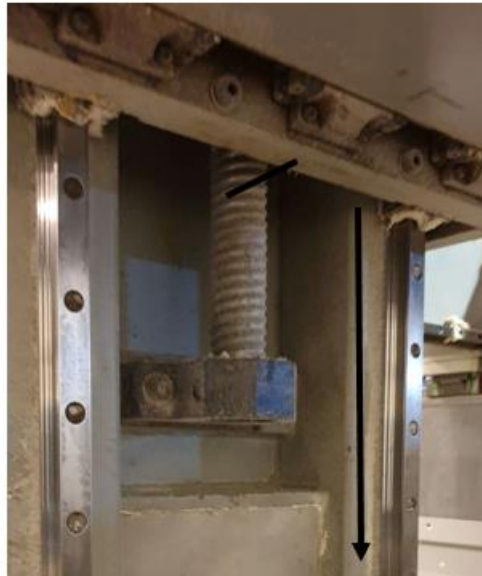
Figura 3.37 - Constrangimentos estruturais associados ao veio fuso de esferas e aos seus rolamentos.
