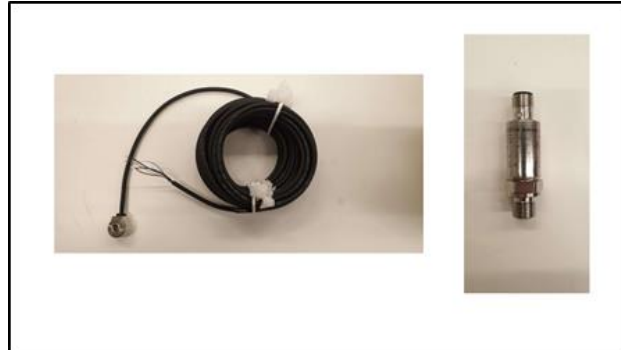
Figura 3.32 - Sensor de Vibração VSA005 (esquerda); Sensor de Vibração VVB010 (direita); submetidos aos primeiros testes de ligação para verificação de funcionamento.
