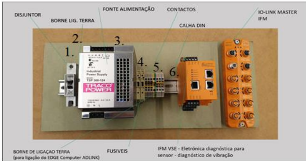
Figura 3.30 - Disposição e montagem dos elementos em banca e respetiva calha DIN.
