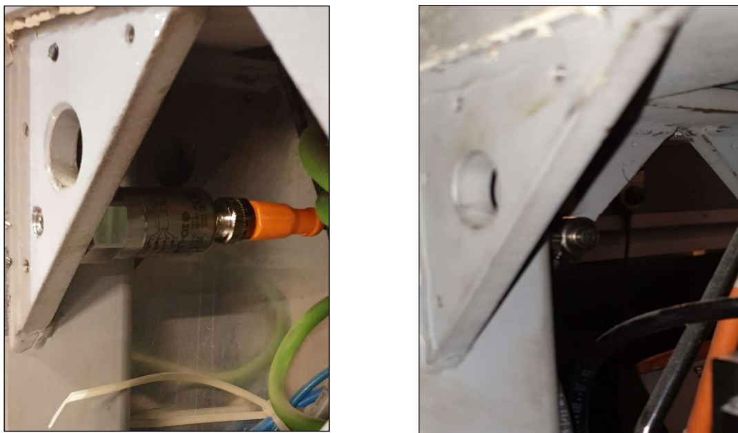
Figura 3.40 - Implementação do sensor de vibração axial VVB010 no corpo do cabeçote na direção do eixo X (esquerda); Sensor de vibração axial VSA 005 implementado na estrutura do cabeçote na direção do eixo Y (direita).
