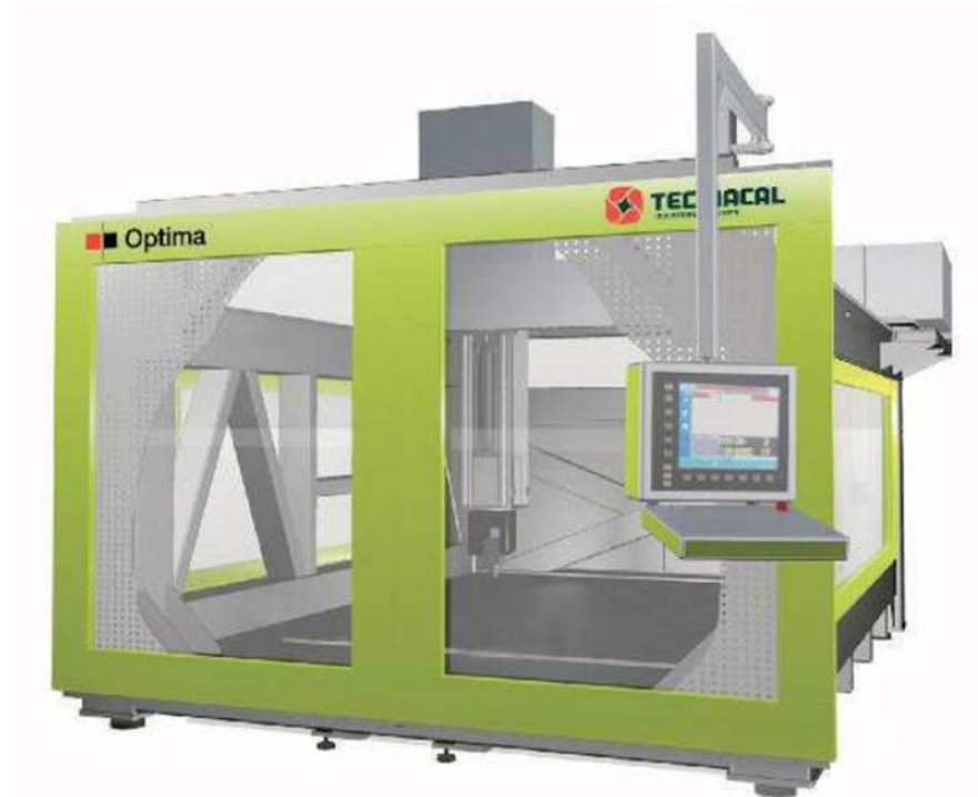
Figura 3.2 - Equipamento alvo do projeto de dissertação. Fresadora CNC de 5 Eixos com controlador Fagor .
