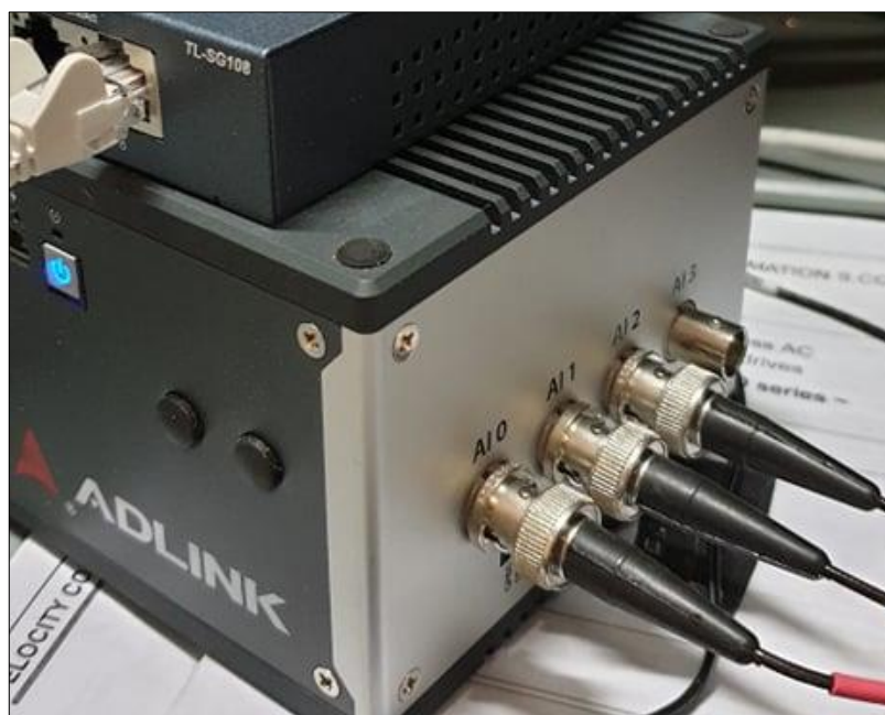
Figura 3.13 - Sensor Triaxial Bruel & Kjaer conectado ao edge computer por IEPE.
