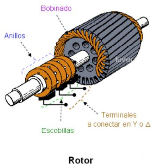
Figura 2.4: Aspetos construtivos do rotor bobinado. Fonte: [7]
