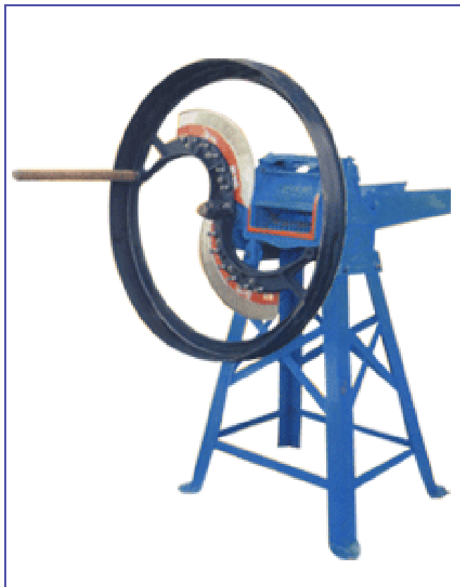
Figura 23: Máquina de forragem destinada a pequenos agricultores.
