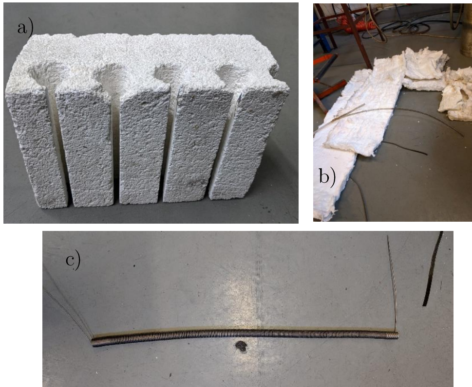
Figura 3.4 – Tijolo refratário (a), manta de fibra cerâmica (b), resistência elétrica (c).
