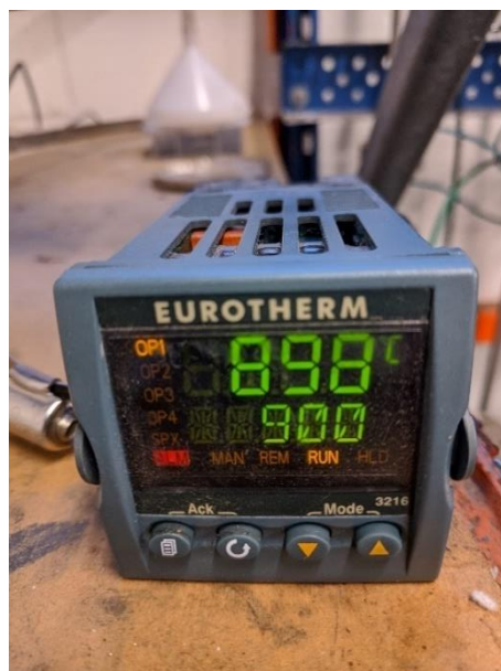
Figura 3.8 - Controlador de Temperatura.
