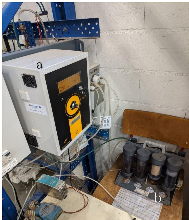
Figura 3.9 – Analisador de gás de produção (a) e sistema de tratamento dos gases (b).
