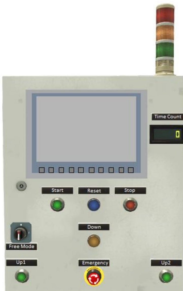
Figura 50 – Modelo do novo painel de controlo
