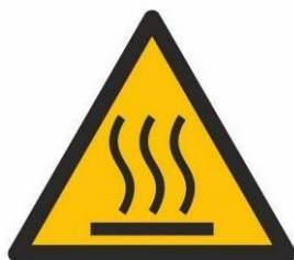
Figura 47 – Sinal de aviso contra superfícies quentes
