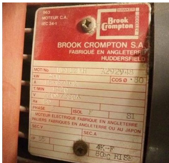
Figura 84 – Placa com as características do motor do conjunto hidráulico de alta pressão
