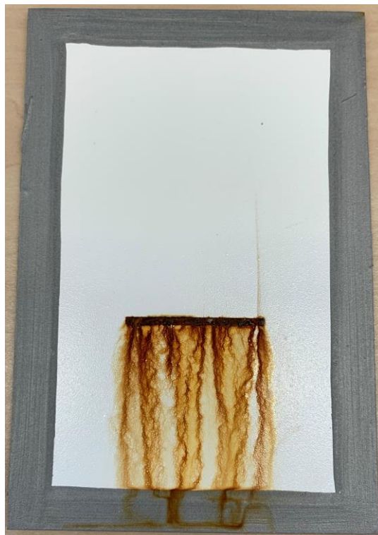
Figura 29 - Provete com esmalte R3 após 120 horas em nevoeiro salino.
