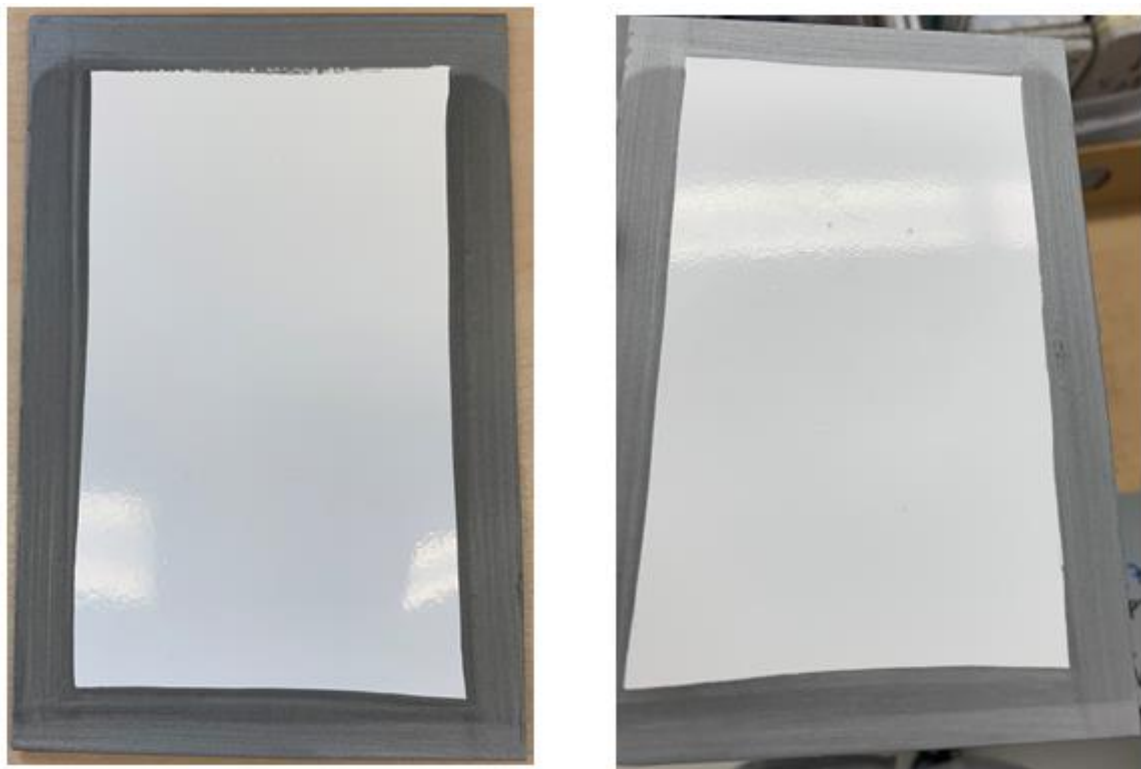
Figura 18 - Provates com esmalte R6 após ensaios de câmara de condensação de 48 e 120 horas, respetivamente.
