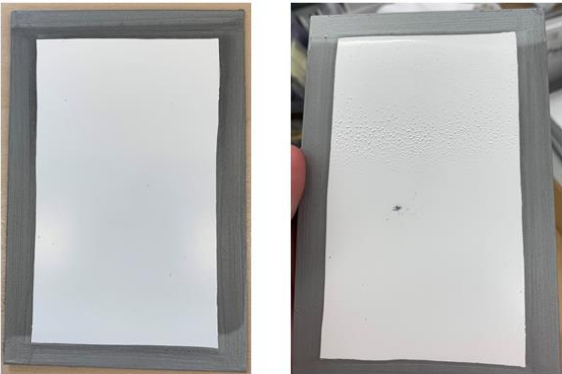
Figura 14 - Provetes de esmalte R1 após ensaios de câmara de condensação de 48 e 120 horas, respectivamente.
