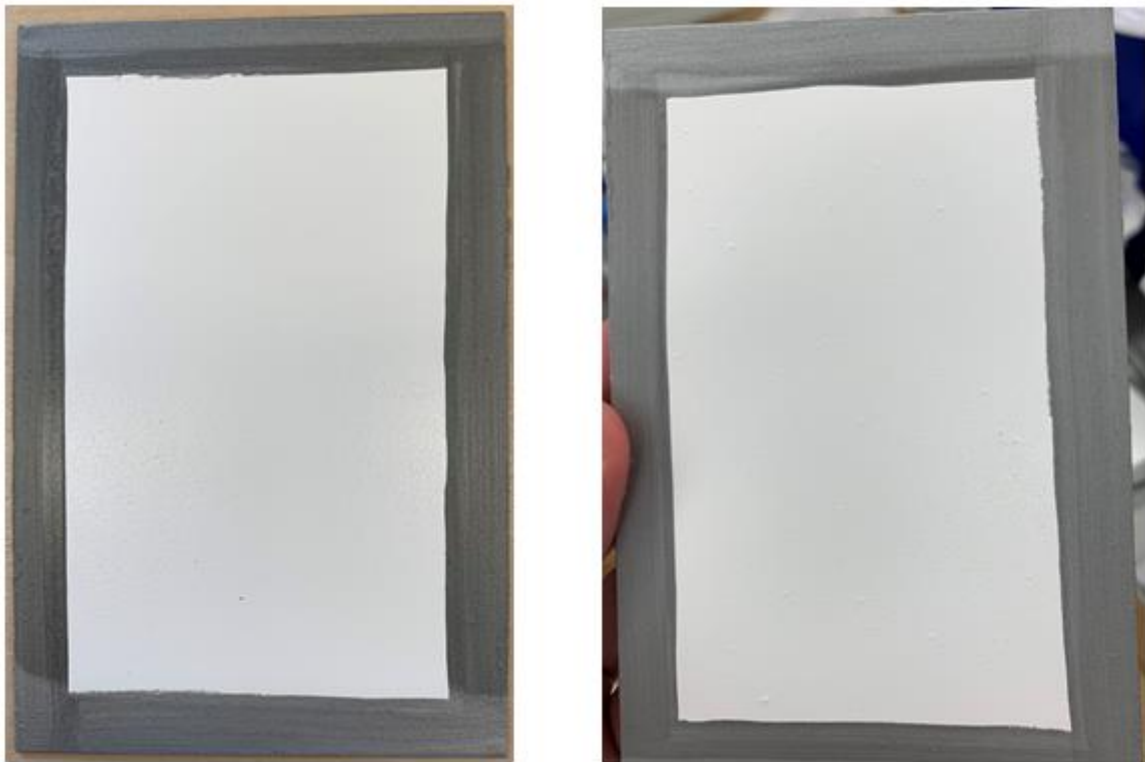
Figura 16 - Provetes com esmalte R3 após ensaios de câmara de condensação de 48 e 120 horas, respectivamente.
