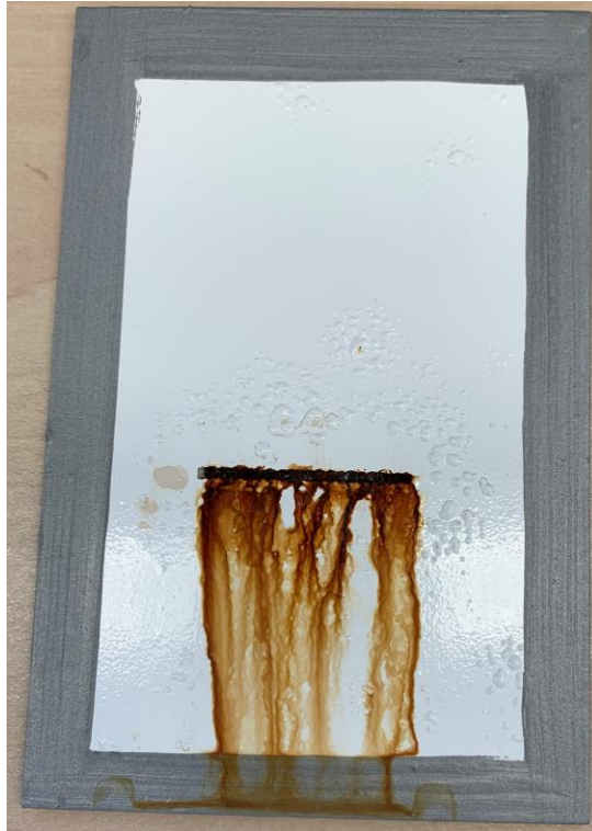
Figura 26 - Provete com esmalte C4 após 120 horas em nevoeiro salino.
