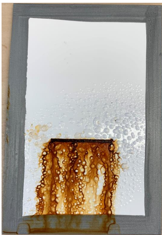
Figura 23 - Provete com esmalte C1 após 120 horas em nevoeiro salino.
