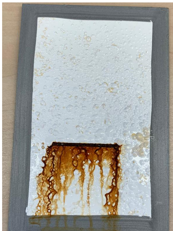
Figura 24 - Provete com esmalte C2 após 120 horas em nevoeiro salino.
