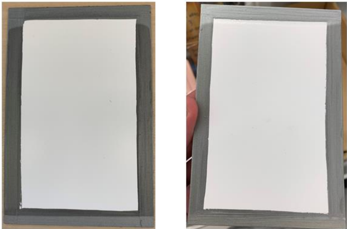
Figura 12 - Provete de esmalte C3 após ensaios de câmara de condensação de 48 e 120 horas, respectivamente.
