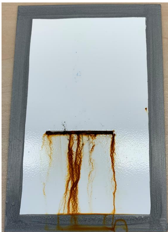
Figura 25 - Provete com esmalte C3 após 120 horas em nevoeiro salino.
