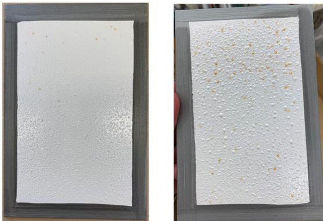
Figura 21 - Provetes com esmalte R12 após ensaios de câmara de condensação de 48 e 120 horas, respetivamente.
