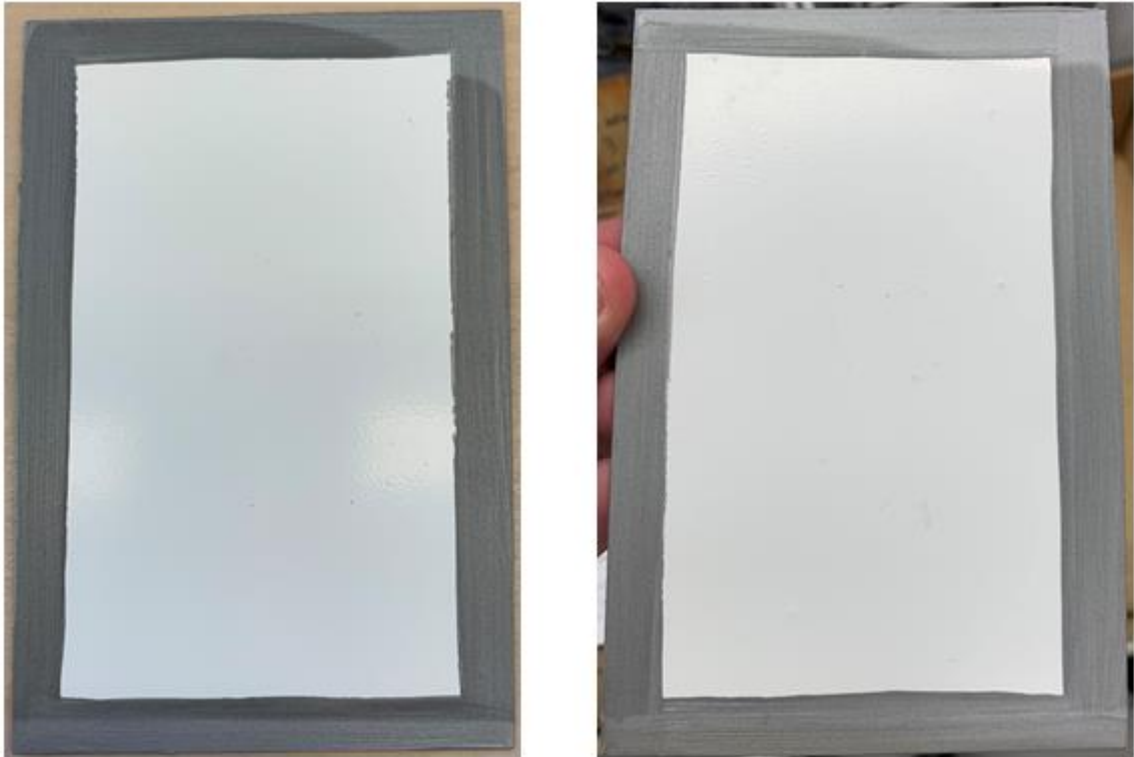
Figura 13 - Provetes de esmalte C4 após ensaios de câmara de condensação de 48 e 120 horas, respectivamente.
