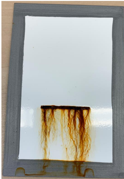
Figura 31 - Provete com esmalte R6 após 120 horas em nevoeiro salino.
