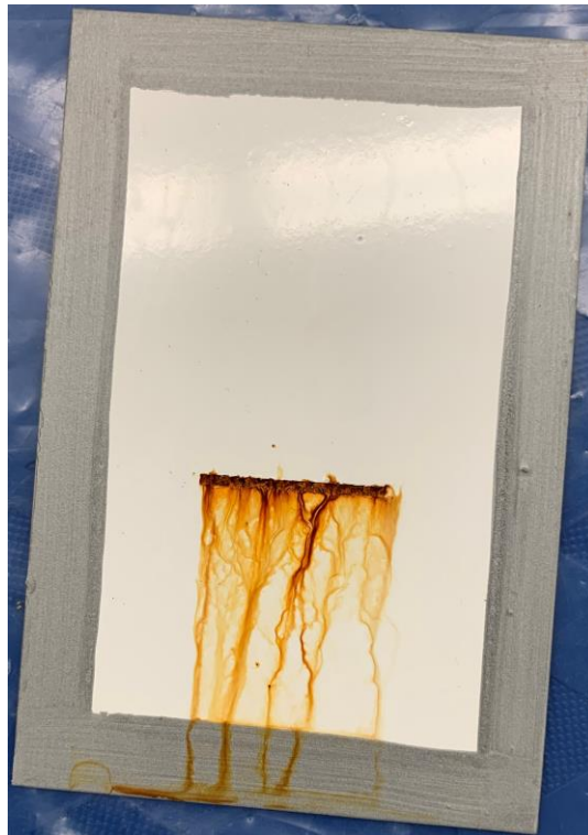
Figura 27 - Provete com esmalte R1 após 120 horas em nevoeiro salino.
