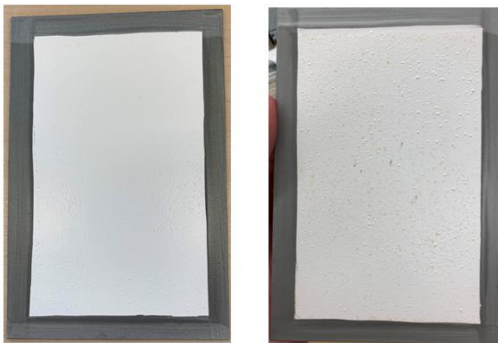
Figura 10 - Provetes de esmalte C1 após ensaios de câmara de condensação de 48 e 120 horas, respetivamente.
