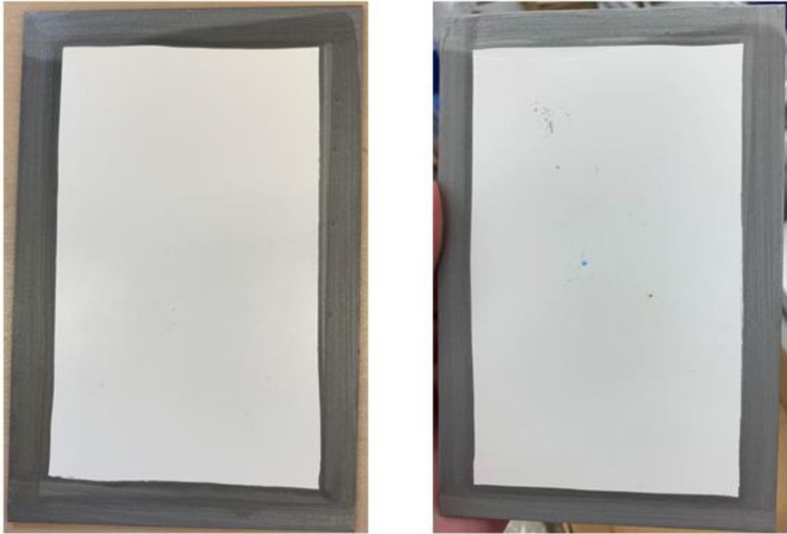
Figura 19 - Provetes com esmalte R7 após ensaios de câmara de condensação de 48 e 120 horas, respetivamente.
