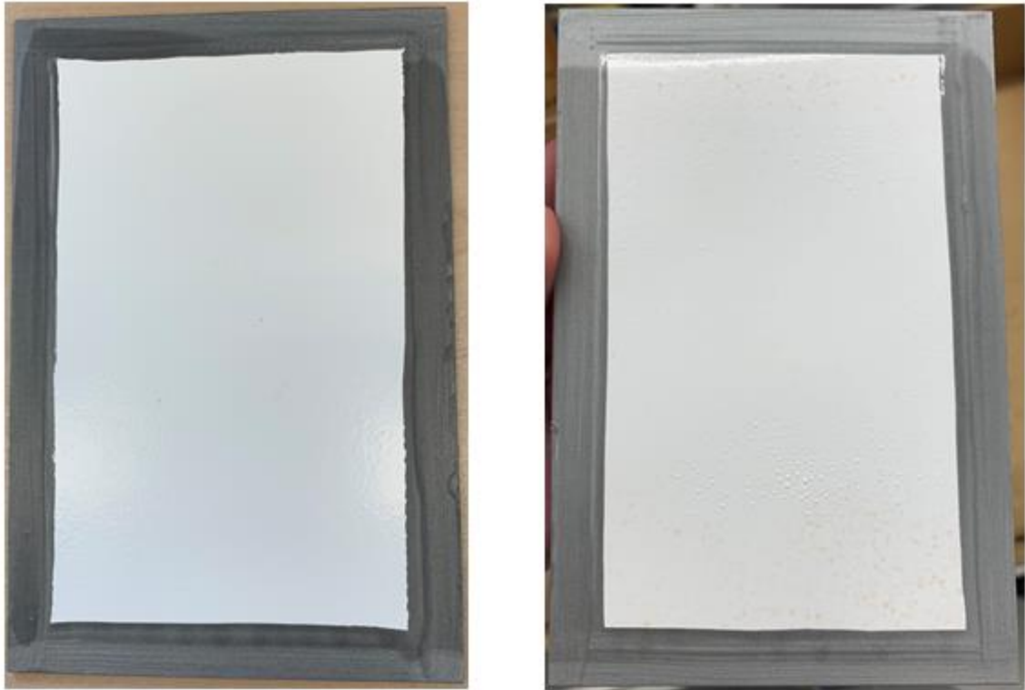
Figura 15 - Provetes com esmalte R2 após ensaios de câmara de condensação de 48 e 120 horas, respectivamente.
