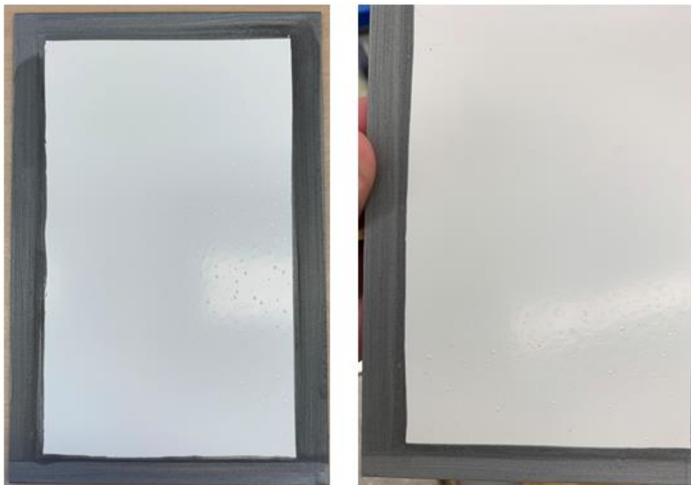
Figura 9 - Provetes de esmalte P após ensaios de câmara de condensação de 48 e 120 horas, respetivamente.
