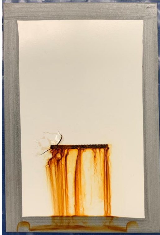
Figura 34 - Provete com esmalte R12 após 120 horas em nevoeiro salino.
