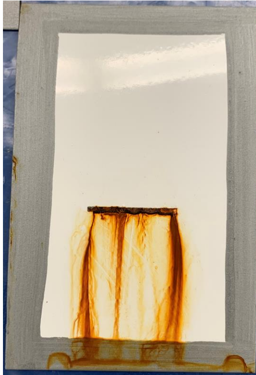
Figura 30 - Provete com esmalte R5 após 120 horas em nevoeiro salino.
