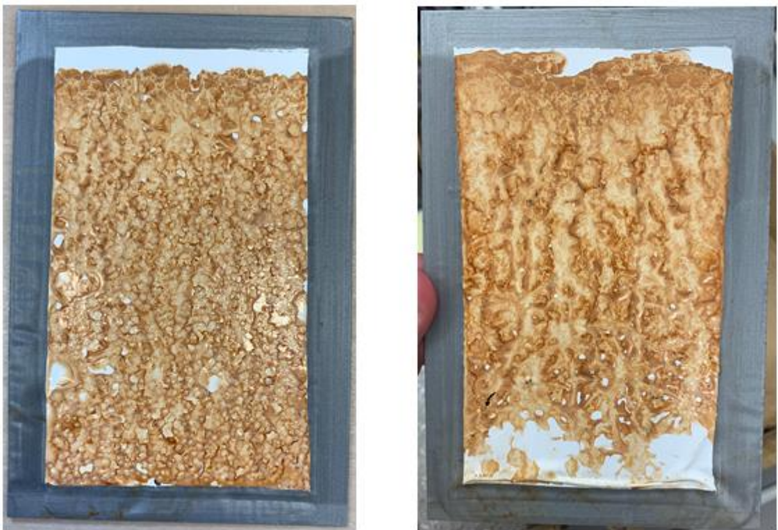
Figura 20 - Provetes com esmalte R10 após ensaios de câmara de condensação de 48 e 120 horas, respetivamente.
