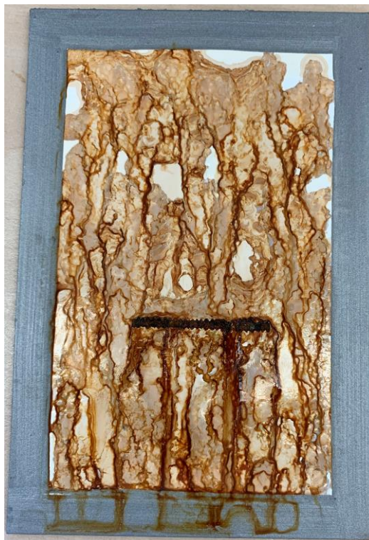
Figura 33 - Provete com esmalte R10 após 120 horas em nevoeiro salino.
