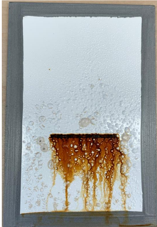
Figura 28 - Provete com esmalte R2 após 120 horas em nevoeiro salino.
