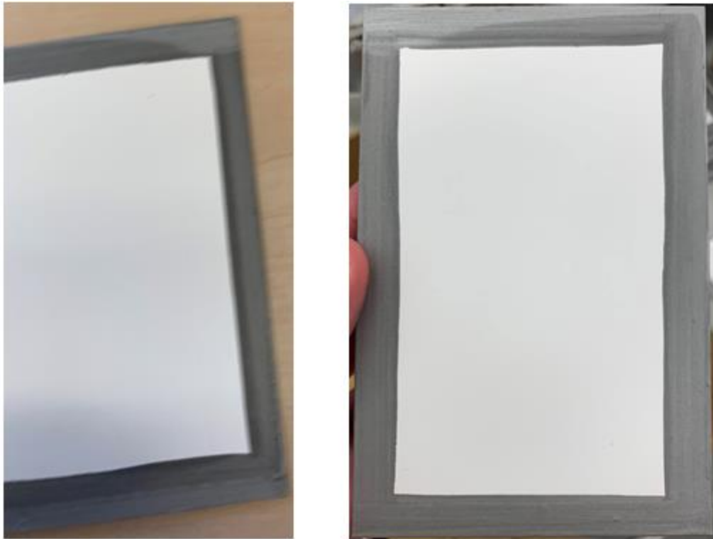
Figura 17 - Provates com esmalte R5 após ensaios de câmara de condensação de 48 e 120 horas, respetivamente.
