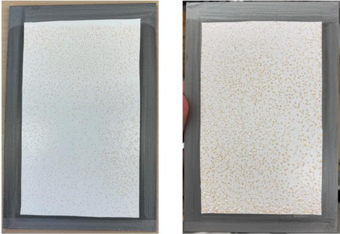
Figura 11 - Provete de esmalte C2 após ensaios de câmara de condensação de 48 e 120 horas, respectivamente.
