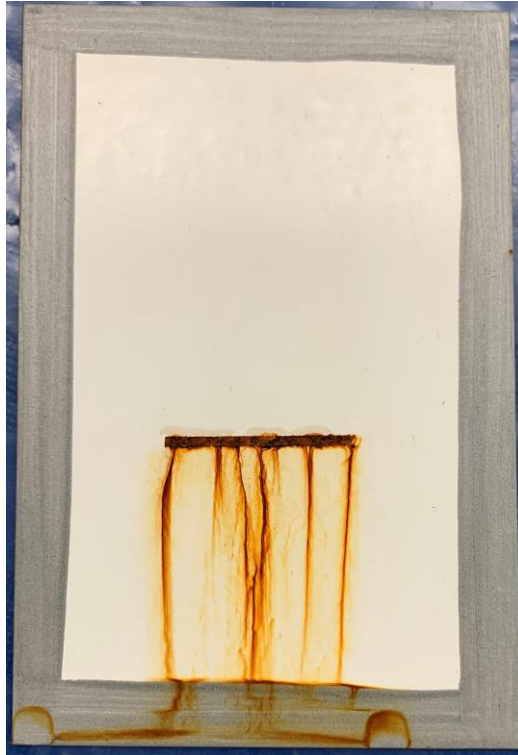
Figura 32 - Provete com esmalte R7 após 120 horas em nevoeiro salino.
