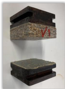
Figura 4. 4 - Provete fratura pela linha de cola.
