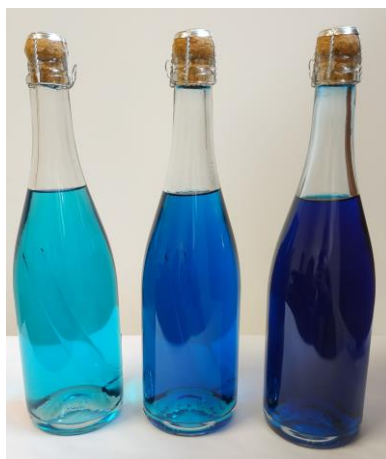
Figura 3.7 - Garrafas com azul de metileno em fases diferentes de oxidação, por ordem crescente de grau de oxidação (da esquerda para a direita).
