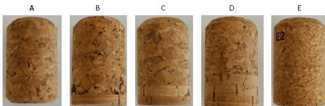
Figura 3.1 - Rolhas utilizadas no projeto: A) Rolha Aglomerada; B) Rolha de 1 Disco (1D); C) Rolha de 2 Discos (2D); D) Rolha de 3 Discos (3D); E) Rolha Microaglomerada;
