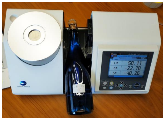
Figura 3.13 - Colorímetro KONICA MINOLTA CR-5 a efetuar uma medição exemplo para este método.
