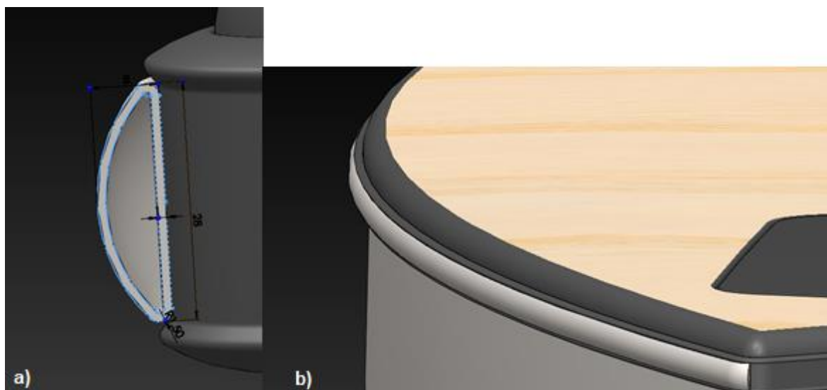
Figura 98 a) perfil da placa de inox do verdugo Sphaera 25, e b) verdugo com a placa de inox após a função Boss Sweep
