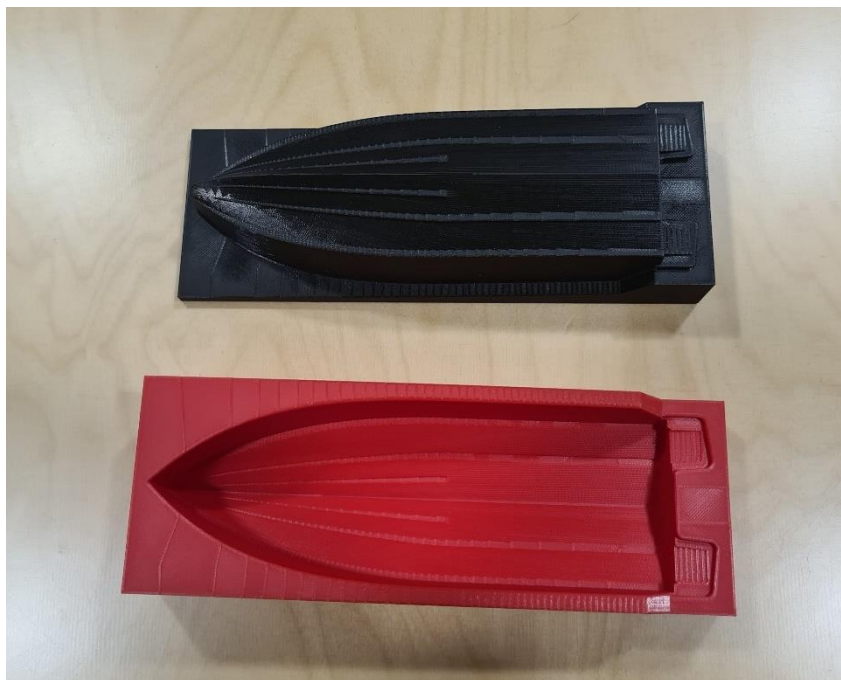
Figura 122 Protótipo do molde do casco e do seu negativo
