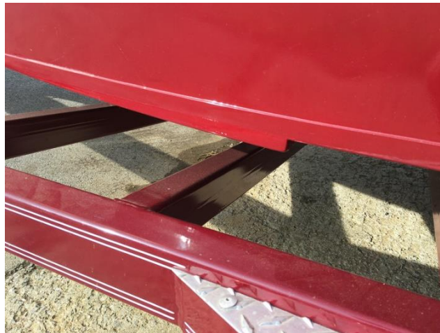
Figura 9 Step de um barco de corrida de 1932 (Ventnor-16 E-Class) [3]
