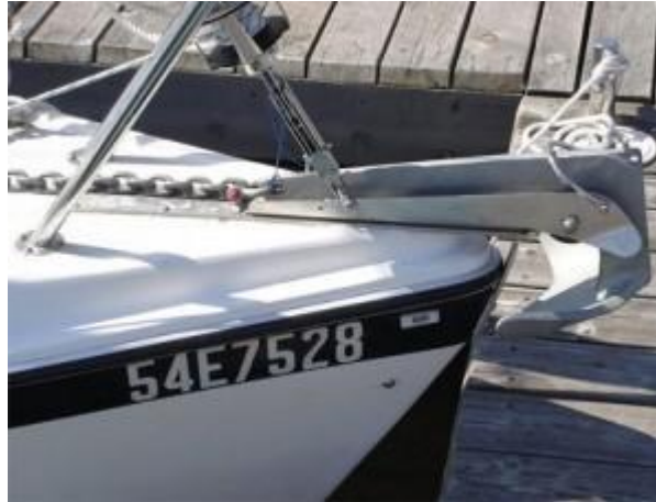
Figura 20 Exemplo de uma âncora do tipo Plow/Scoop instalada num Bow Roller . [8]
