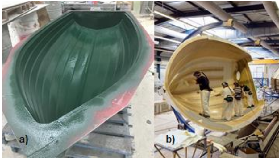
Figura 23 a) molde após a aplicação do gel coat [11], e b) processo de laminação da FV [12]
