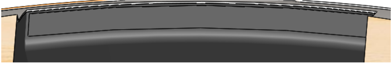
Figura 88 Rebaixo no degrau da ré para instalar a teca
