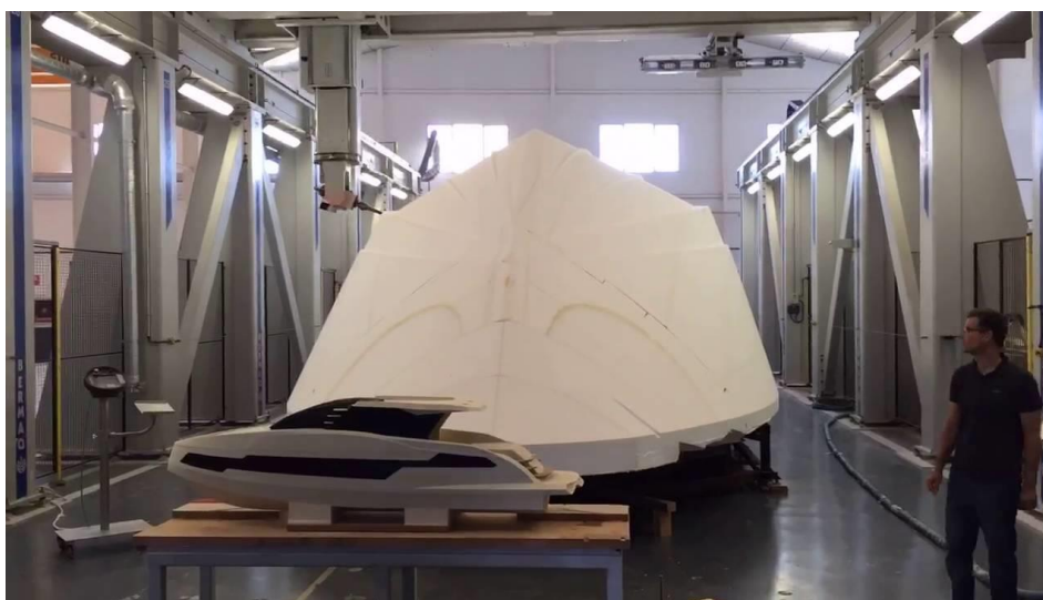
Figura 22 Máquina CNC de cinco eixos adequado para trabalhar em materiais pouco duros, na imagem o poliestireno expandido [10]
