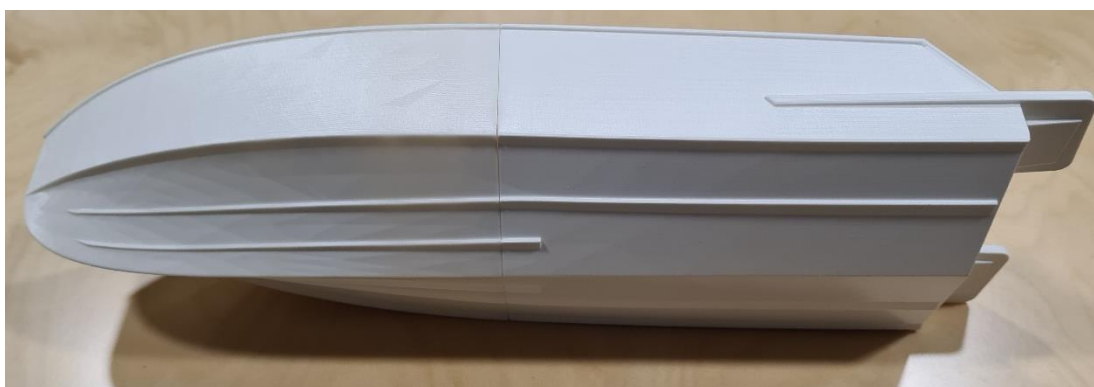
Figura 120 Protótipo impresso por FA, do casco Tradicional.
