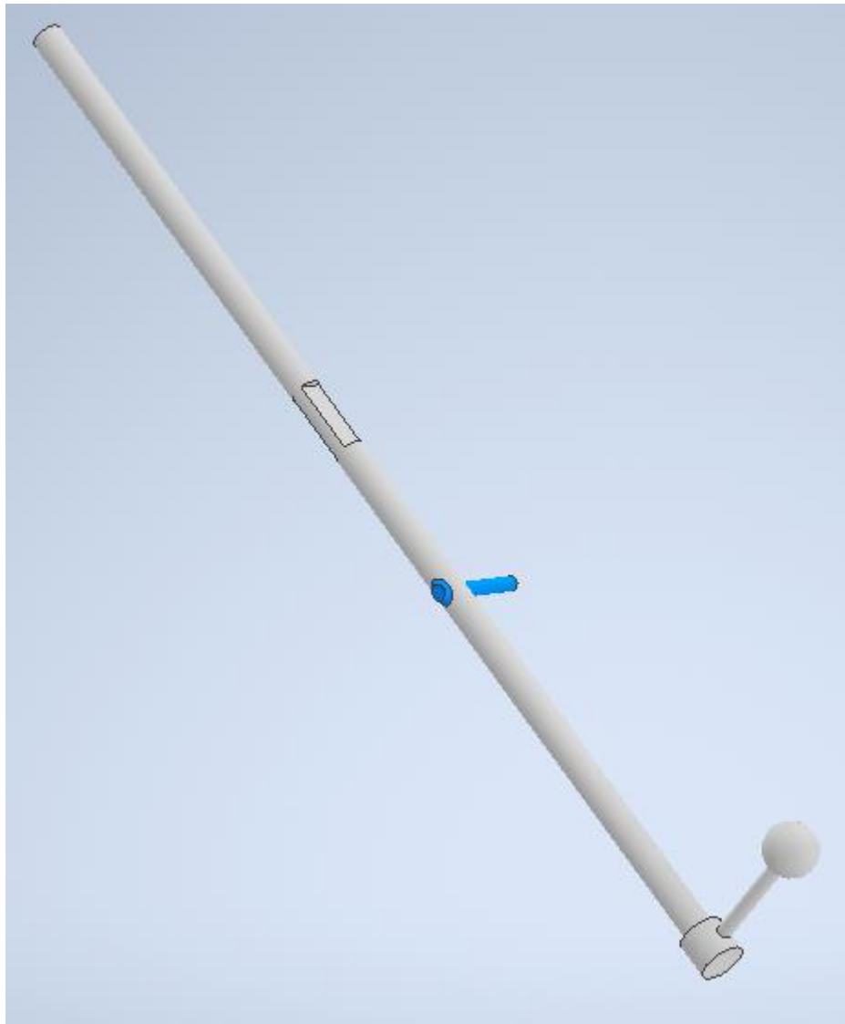
Figura 118- Novo pino implementado no veio de travamento
