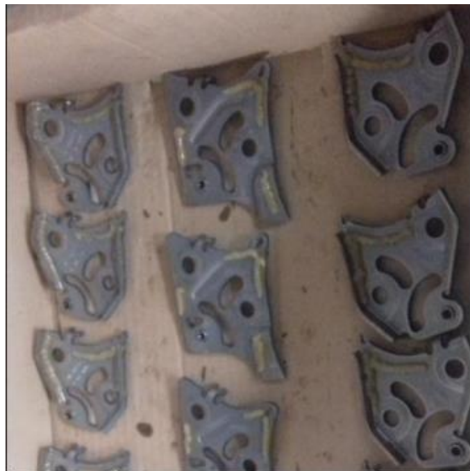
Figura 65-Aplicação de massa nas caixas de proteção
