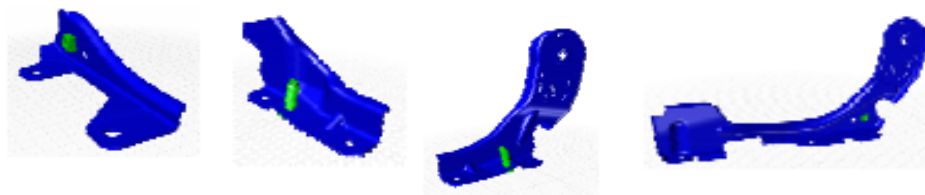
Figura 45-Representação das posições das porcas nos Goussets (duas imagens à esquerda), suporte de cinto (central) e Riser (direita) (Faurecia(b) 2020)
