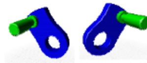
Figura 49-Rebitagem dos pinos nos trancadores (Faurecia(b) 2020)
