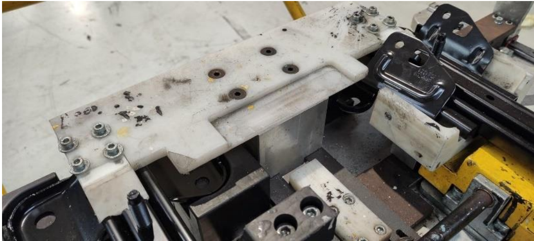
Figura 76- Placa de nylon para proteger as corrediças
