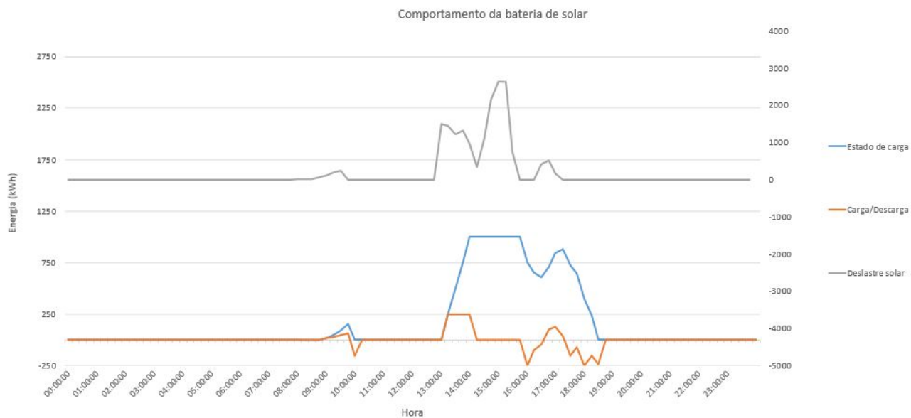
Figura 4.3: Comportamento da bateria solar(1 MWh/ 1MW) no dia 16 de Fevereiro de 2015
