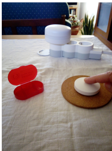
Figura 7.8: Luz desligada quando o utente carrega no botão
