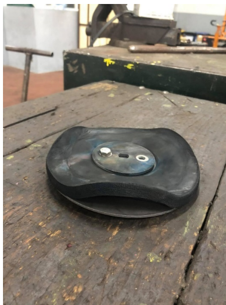
Figura 5.8: Válvula de evacuação deformada
