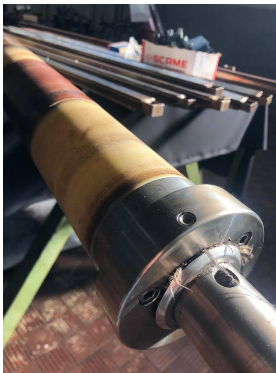
Figura 5.13: Niple de lubrificação do rolo curvo
