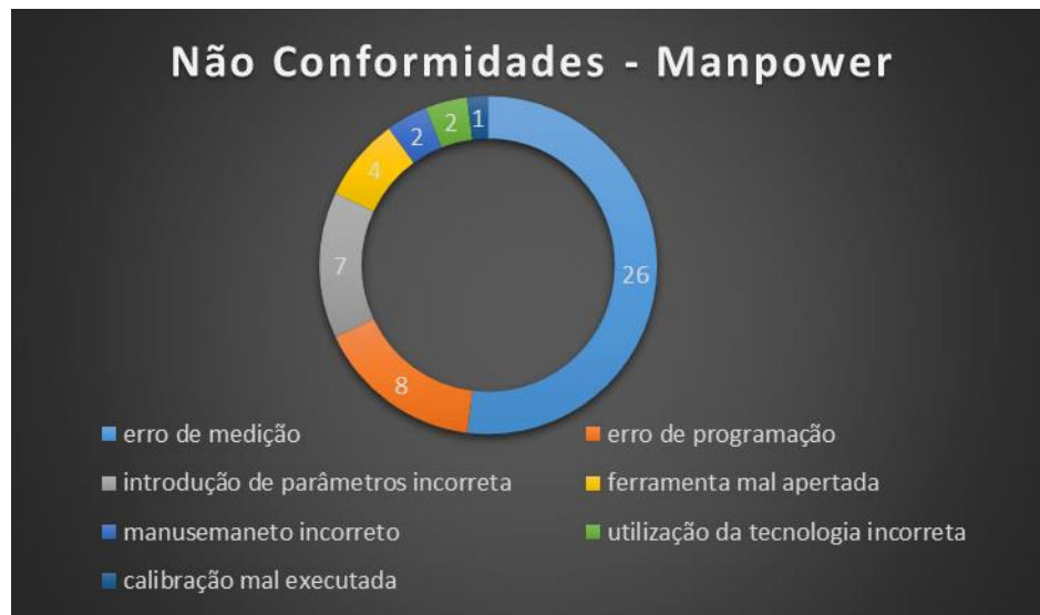
Figura 12 - Não conformidades provocadas pelos colaboradores
