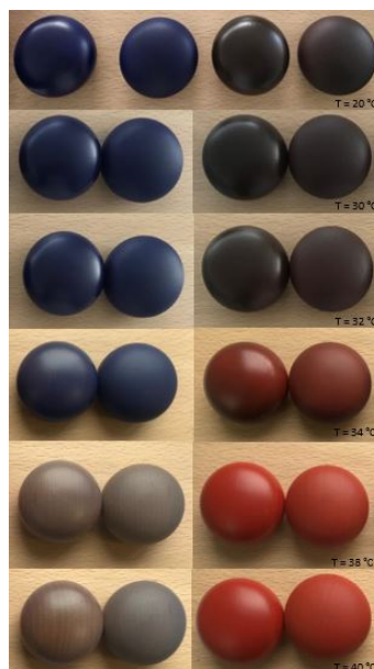
Figura 4.14: Alteração de cor à medida que aumenta a temperatura para cápsulas de madeira com verniz de acabamento termocrômico a quente.
