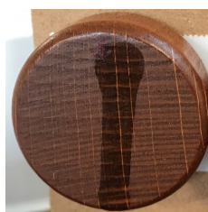
Figura A.1: Representação do procedimento do Teste de Resistência ao Álcool alternativo
