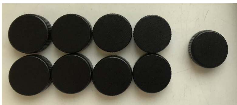
Figura C.1: Resultados obtidos após o teste de resistência ao álcool. A cápsula padrão encontra-se à direita.
