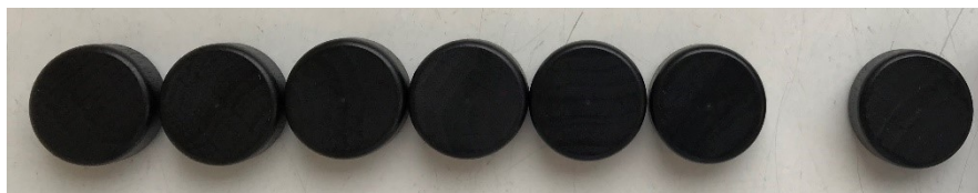
Figura C.2: Resultados obtidos após o teste de resistência ao álcool. A cápsula padrão encontra-se à direita.
