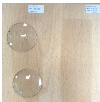
Figura 3.6: Ilustração do teste de resistência química ao álcool nos filmes.
