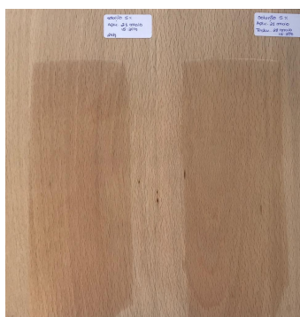
Figura 3.5: Placa de madeira com filmes de solução, com 5 % de microcápsulas, aplicados.
