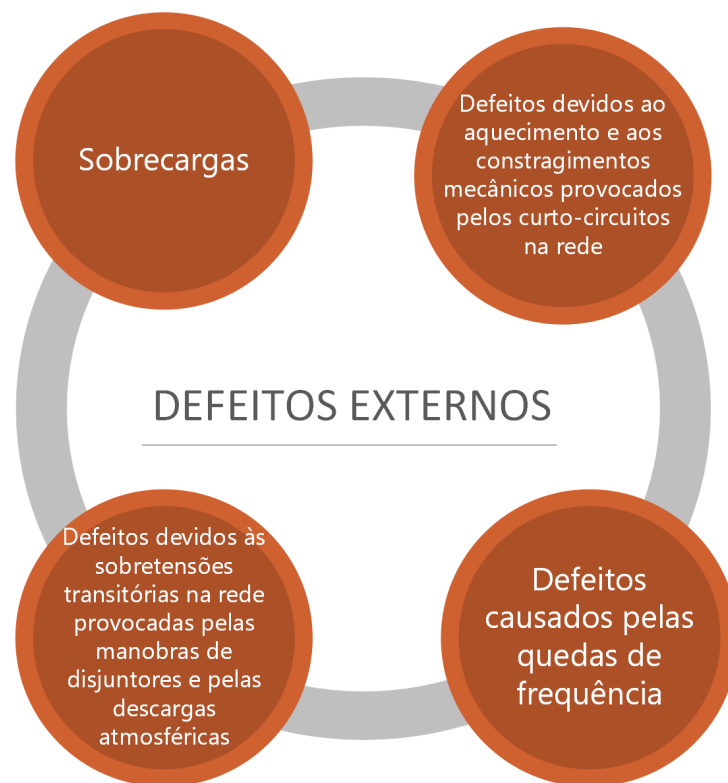
Figura 4.2: Defeitos Externos do Transformador de Potência
