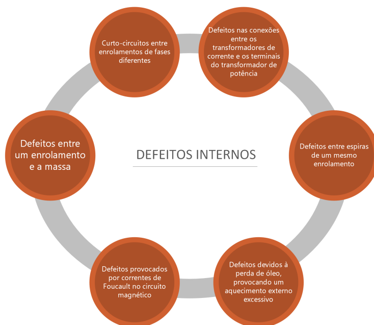
Figura 4.1: Defeitos Internos do Transformador de Potência
