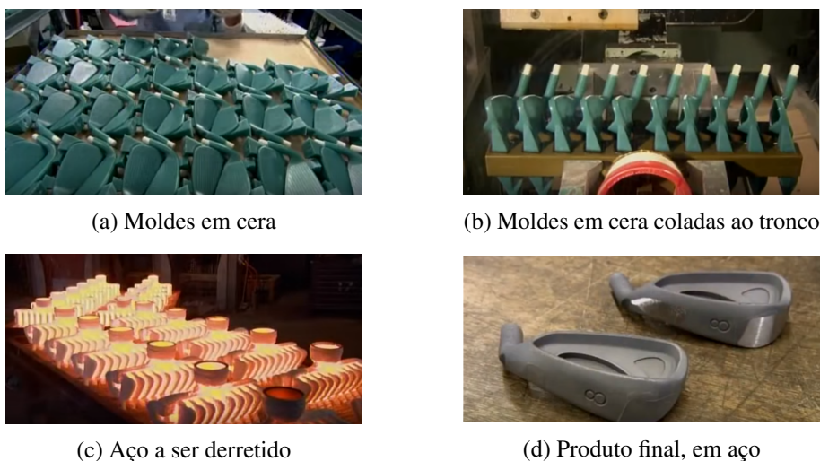
Figura 1.1: Algumas tarefas da produção de peças em aço pelo processo de fundição por cera perdida.
