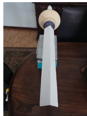
(d) Plano de colagem, com normal a fazer ângulo de 40 graus.
