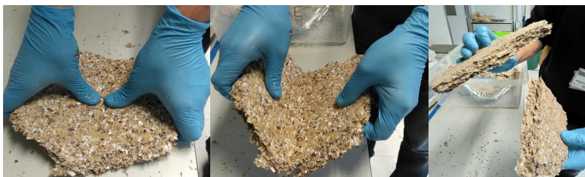
Figura 19 - Ilustração da quebra da placa S1.
