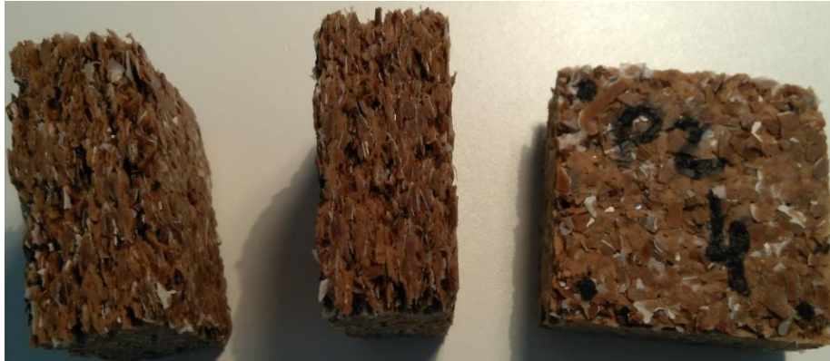
Figura 25 - Aparência dos provetes provenientes da placa P2, após ensaio de água em ebulição.
