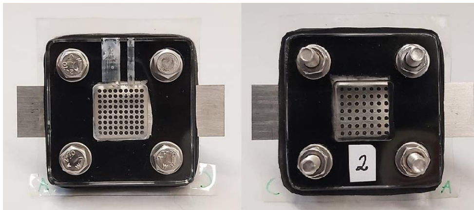
Figura 3.1 - pDEFC utilizada nos testes experimentais.
