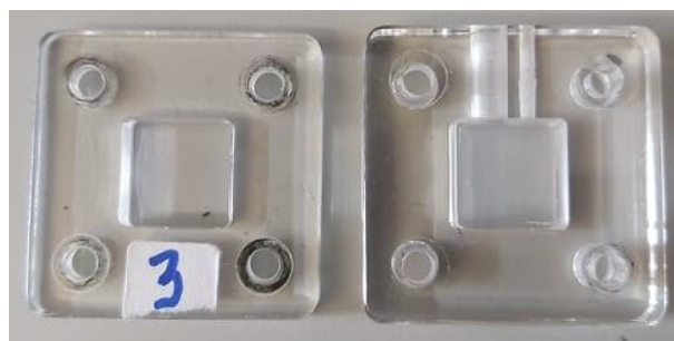
Figura 3.5 - Placas de fecho utilizadas na célula.
