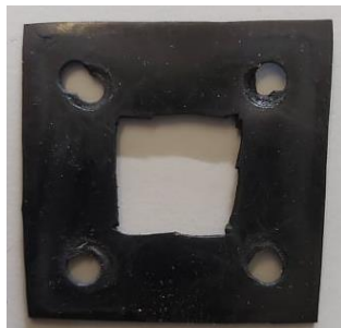
Figura 3.4 - Placa isolante de borracha utilizada na célula.
