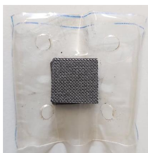
Figura 3.2 - Exemplo de uma MEA utilizada.
