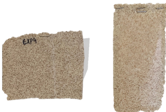
Figura A.1.35 - Amostra com uma fração mássica de hematite de 1,5 % e pré-skin.
