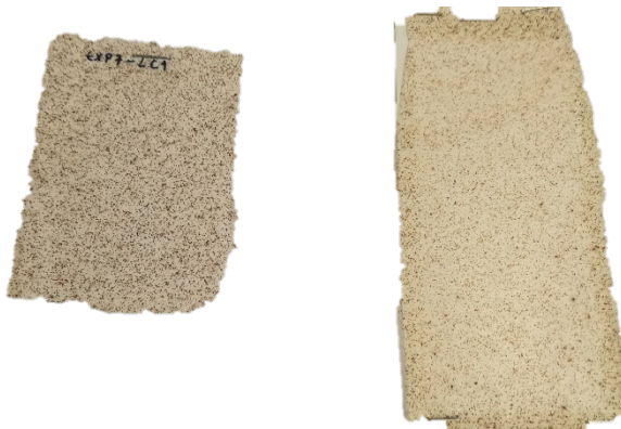
Figura A.1.47 - Amostra com uma fração mássica de hematite de 0,25 % e laca segundo a combinação LC1.
