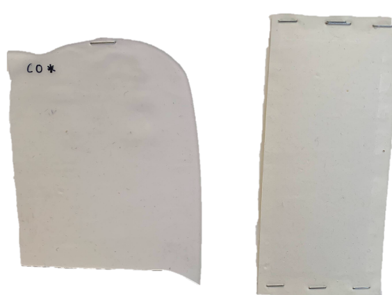
Figura A.1.6 - Controlo C0* antes e após o ensaio de solidez à luz.
