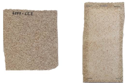
Figura A.1.48 - Amostra com uma fração mássica de hematite de 0,25 % e laca segundo a combinação LC2.
