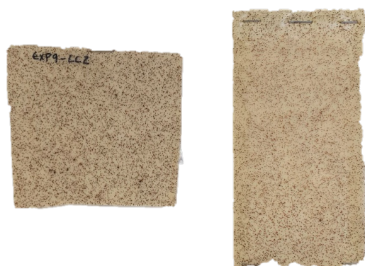
Figura A.1.43 - Amostra com uma fração mássica de hematite de 2 %, pré-skin e laca segundo a combinação LC2.
