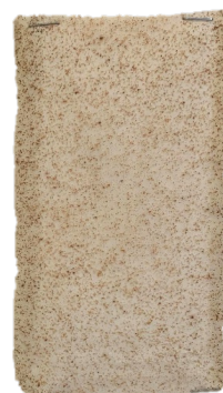
Figura A.1.24 - Amostra com uma fração mássica de hematite de 0,25 %, pré-skin e laca segundo a combinação LC3.
