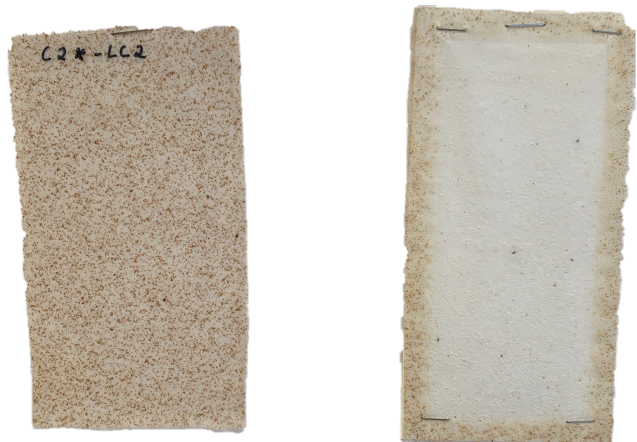
Figura A.1.18 - Controlo C2*-LC2 antes e após o ensaio de solidez à luz.
