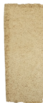
Figura A.1.22 - Amostra com uma fração mássica de hematite de 0,25 %, pré-skin e laca segundo a combinação LC1.
