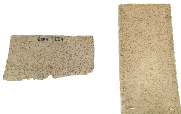
Figura A.1.37 - Amostra com uma fração mássica de hematite de 1,5 %, pré-skin e laca segundo a combinação LC1.
