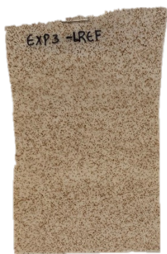
Figura A.1.21 - Amostra com uma fração mássica de hematite de 0,25 %, pré-skin e laca segundo a combinação LREF.
