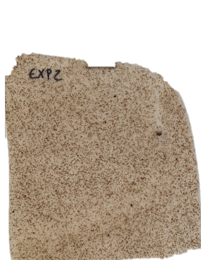
Figura A.1.23 - Amostra com uma fração mássica de hematite de 0,25 %, pré-skin e laca segundo a combinação LC2.
