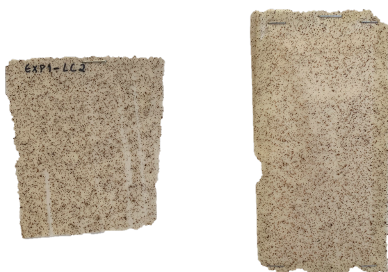
Figura A.1.33 - Amostra com uma fração mássica de hematite de 1 %, pré-skin e laca segundo a combinação LC2.
