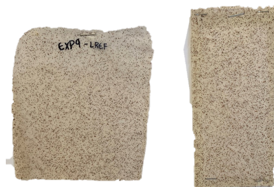
Figura A.1.41 - Amostra com uma fração mássica de hematite de 2 %, pré-skin e laca segundo a combinação LREF.
