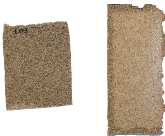
Figura A.1.20 - Amostra com uma fração mássica de hematite de 0,25 % e pré-skin.
