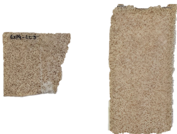
Figura A.1.39 - Amostra com uma fração mássica de hematite de 1,5 %, pré-skin e laca segundo a combinação LC2.
