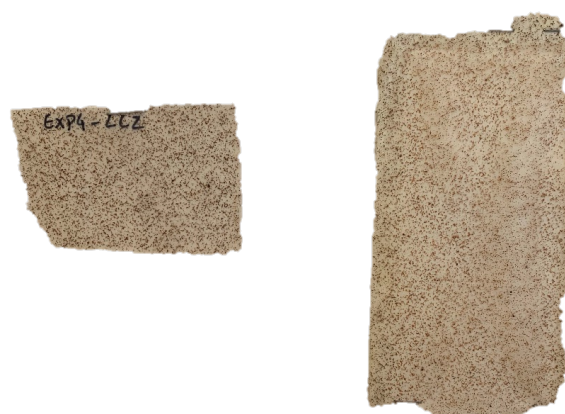
Figura A.1.38 - Amostra com uma fração mássica de hematite de 1,5 %, pré-skin e laca segundo a combinação LC2.
