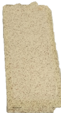
Figura A.1.67 - Amostra com uma fração mássica de hematite de 2 % e laca segundo a combinação LC1.
