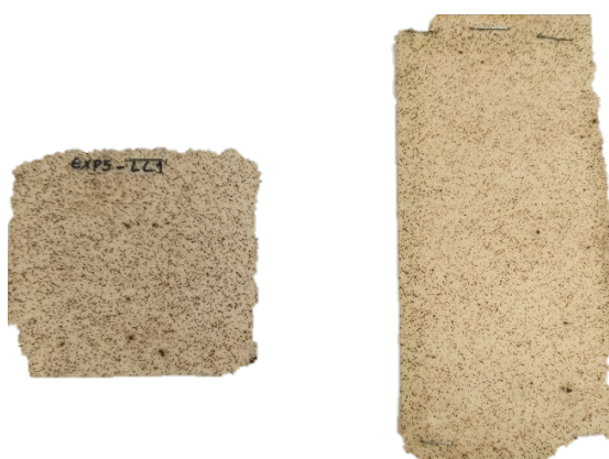
Figura A.1.57 - Amostra com uma fração mássica de hematite de 1 % e laca segundo a combinação LC1.
