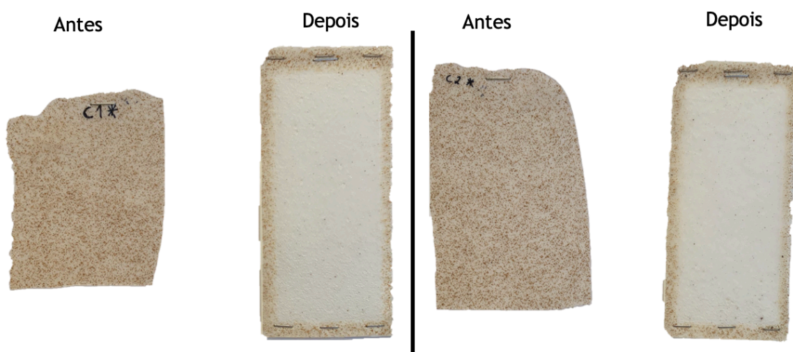
Figura 4.1 - Comparação visual entre os controlos C1* e C2* antes e após o ensaio de solidez à luz.
