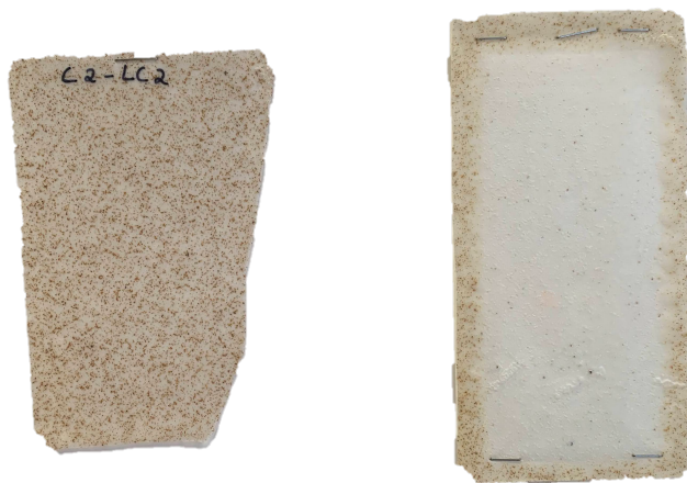
Figura A.1.13 - Controle C2-LC2 antes e após o ensaio de solidez à luz.
