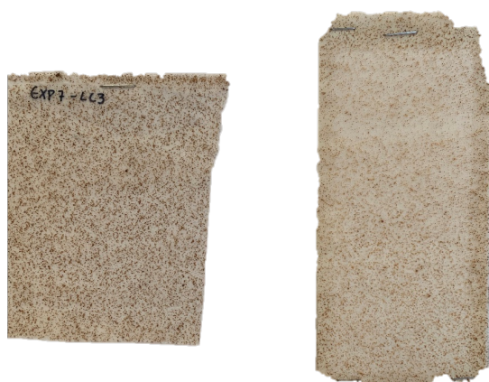
Figura A.1.49 - Amostra com uma fração mássica de hematite de 0,25 % e laca segundo a combinação LC3.
