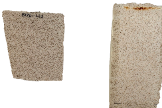
Figura A.1.53 - Amostra com uma fração mássica de hematite de 0,5 % e laca segundo a combinação LC2.
