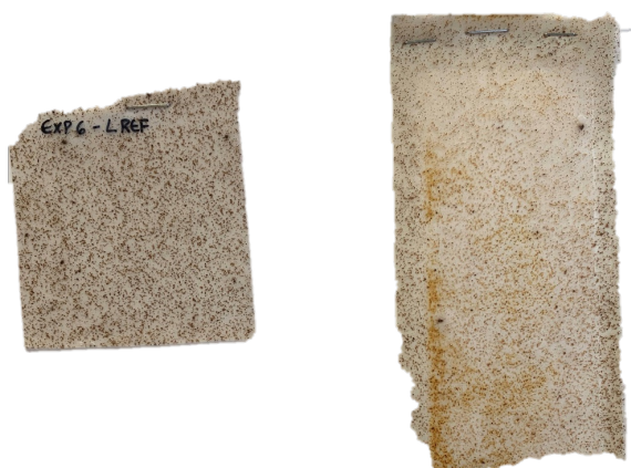
Figura A.1.51 - Amostra com uma fração mássica de hematite de 0,5 % e laca segundo a combinação LREF.
