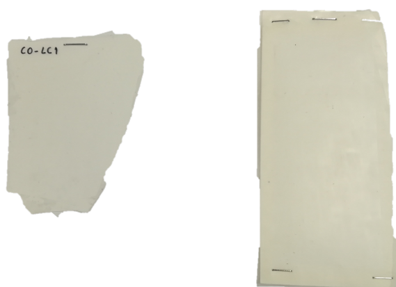
Figura A.1.3 - Controlo C0-LC1 antes e após o ensaio de solidez à luz.
