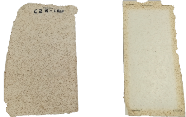
Figura A.1.16 - Controlo C2*-LREF antes e após o ensaio de solidez à luz.
