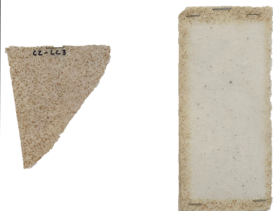
Figura A.1.14 - Controle C2-LC3 antes e após o ensaio de solidez à luz.
