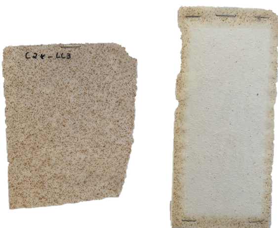
Figura A.1.19 - Controlo C2*-LC3 antes e após o ensaio de solidez à luz.
