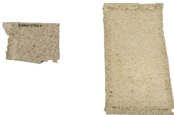
Figura A.1.27 - Amostra com uma fração mássica de hematite de 0,5 %, pré-skin e laca segundo a combinação LC1.
