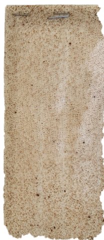
Figura A.1.25 - Amostra com uma fração mássica de hematite de 0,5 % e pré-skin.
