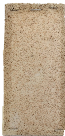
Figura A.1.21 - Amostra com uma fração mássica de hematite de 0,25 %, pré-skin e laca segundo a combinação LREF.
