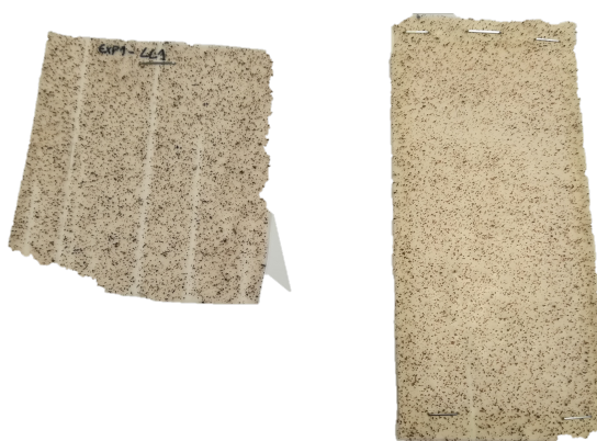
Figura A.3.32 - Amostra com uma fração mássica de hematite de 1 %, pré-skin e laca segundo a combinação LC1.
