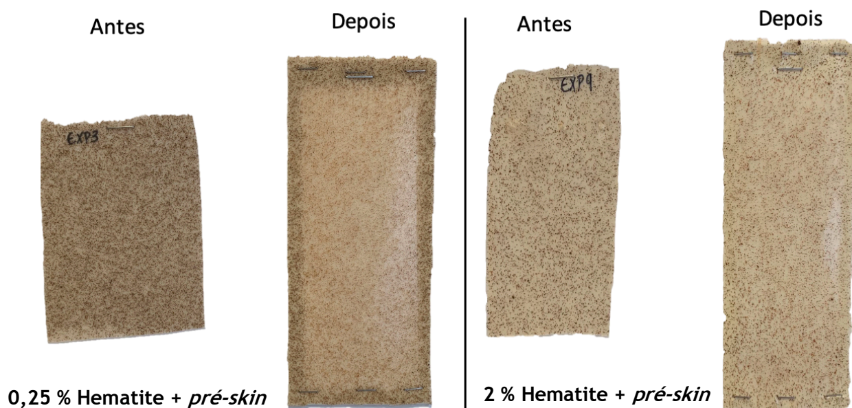
Figura 4.5 - Amostras com frações mássicas de hematite de 0,25 % e 2 % + pré-skin antes e após o ensaio de solidez à luz.
