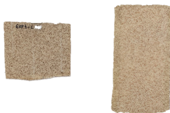
Figura A.1.36 - Amostra com uma fração mássica de hematite de 1,5 %, pré-skin e laca segundo a combinação LREF.
