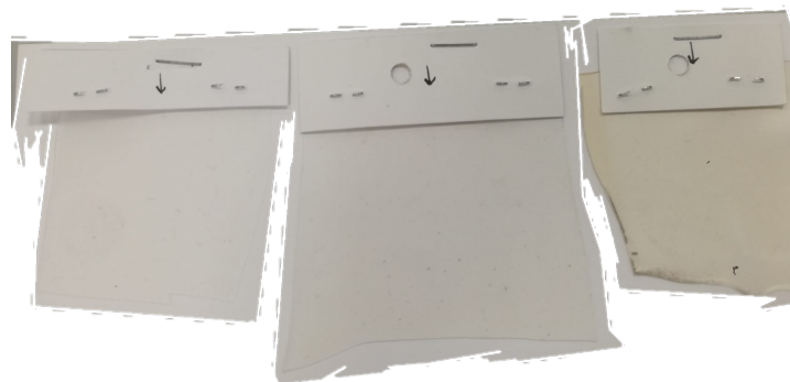
Figura A.4.1 - Resultados obtidos do ensaio de envelhecimento térmico para o controlo C0*.
