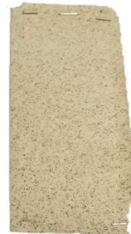
Figura A.1.68 - Amostra com uma fração mássica de hematite de 2 % e laca segundo a combinação LC2.
