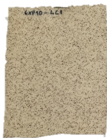
Figura A.1.67 - Amostra com uma fração mássica de hematite de 2 % e laca segundo a combinação LC1.
