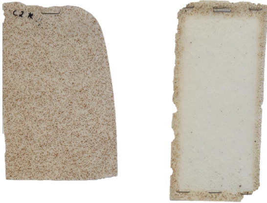
Figura A.1.15 - Controlo C2* antes e após o ensaio de solidez à luz.
