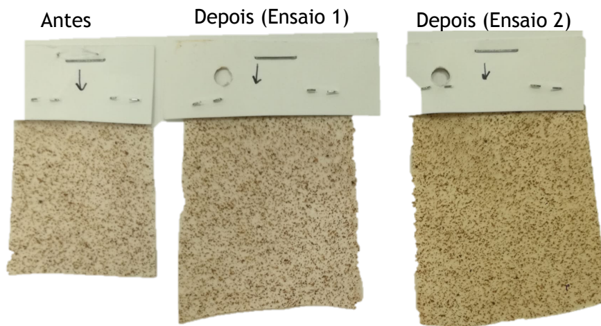
Figura A.4.4 - Resultados obtidos do ensaio de envelhecimento térmico para o controlo C2.
