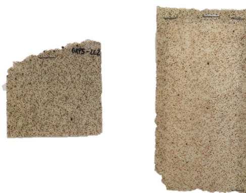
Figura A.1.58 - Amostra com uma fração mássica de hematite de 1 % e laca segundo a combinação LC2.
