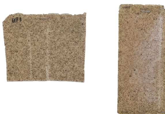
Figura A.1.30 - Amostra com uma fração mássica de hematite de 1 % e pré-skin.
