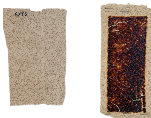
Figura A.1.50 - Amostra com uma fração mássica de hematite de 0,5 %.
