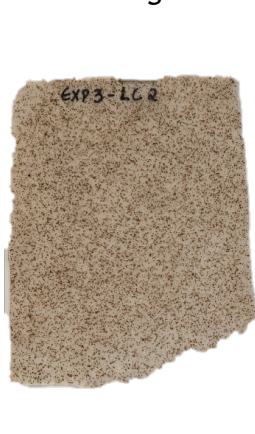
Figura A.1.21 - Amostra com uma fração mássica de hematite de 0,25 %, pré-skin e laca segundo a combinação LREF.
