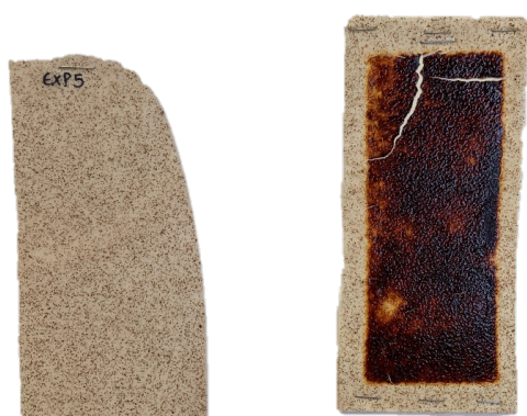
Figura A.1.55 - Amostra com uma fração mássica de hematite de 1 %.
