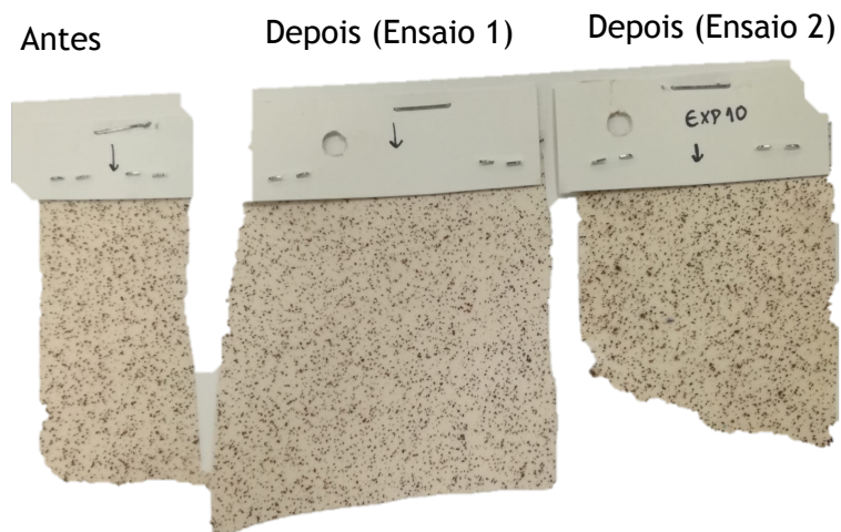
Figura A.4.8 - Resultados obtidos do ensaio de envelhecimento térmico a amostra que contém uma fração mássica de hematite de 2 %.
