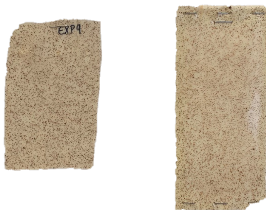
Figura A.1.40 - Amostra com uma fração mássica de hematite de 2 % e pré-skin.
