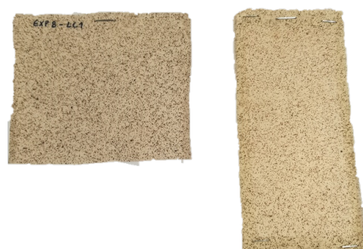
Figura A.1.62 - Amostra com uma fração mássica de hematite de 1,5 % e laca segundo a combinação LC1.
