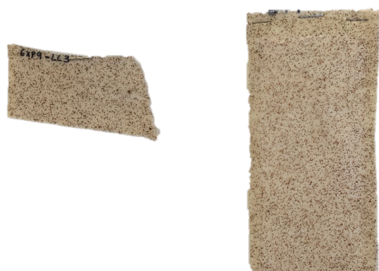
Figura A.1.44 - Amostra com uma fração mássica de hematite de 2 %, pré-skin e laca segundo a combinação LC3.
