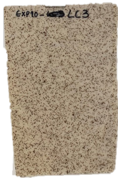
Figura A.1.69 - Amostra com uma fração mássica de hematite de 2 % e laca segundo a combinação LC3.
