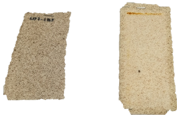
Figura A.1.46 - Amostra com uma fração mássica de hematite de 0,25 % e laca segundo a combinação LREF.
