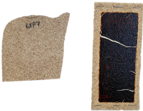
Figura A.1.45 - Amostra com uma fração mássica de hematite de 0,25 %.
