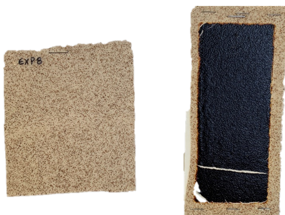
Figura A.1.60 - Amostra com uma fração mássica de hematite de 1,5 %.
