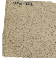
Figura A.1.68 - Amostra com uma fração mássica de hematite de 2 % e laca segundo a combinação LC2.
