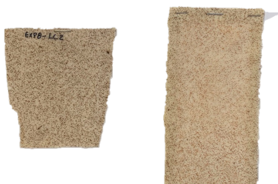
Figura A.1.63 - Amostra com uma fração mássica de hematite de 1,5 % e laca segundo a combinação LC2.
