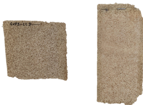
Figura A.1.59 - Amostra com uma fração mássica de hematite de 1 % e laca segundo a combinação LC3.
