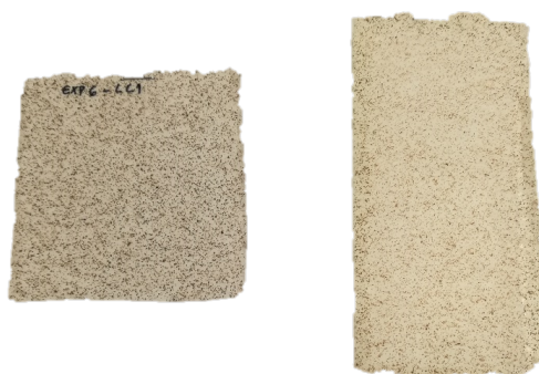
Figura A.1.52 - Amostra com uma fração mássica de hematite de 0,5 % e laca segundo a combinação LC1.
