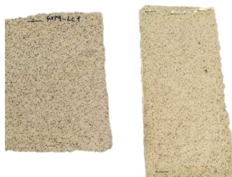
Figura A.1.42 - Amostra com uma fração mássica de hematite de 2 %, pré-skin e laca segundo a combinação LC1.
