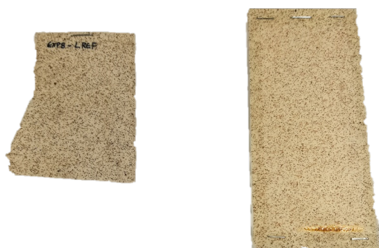
Figura A.1.61 - Amostra com uma fração mássica de hematite de 1,5 % e laca segundo a combinação LREF.
