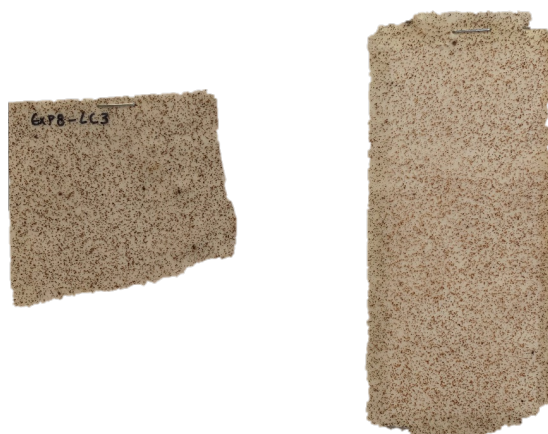
Figura A.1.64 - Amostra com uma fração mássica de hematite de 1,5 % e laca segundo a combinação LC3.
