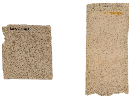
Figura A.1.56 - Amostra com uma fração mássica de hematite de 1 % e laca segundo a combinação LREF.
