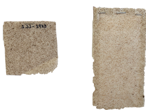
Figura A.1.28 - Amostra com uma fração mássica de hematite de 0,5 %, pré-skin e laca segundo a combinação LC2.
