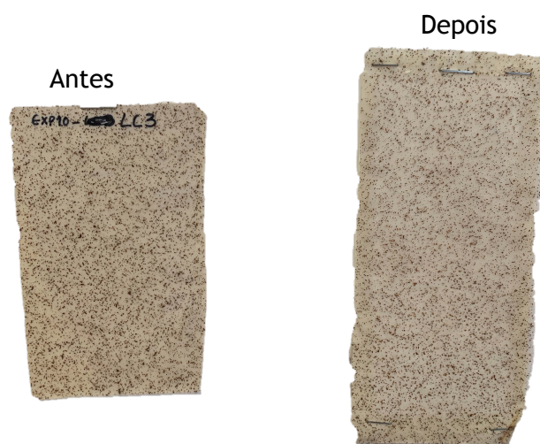
Figura 4.11 - Amostra pigmentada com uma fração de 2 % de hematite, em que foi aplicada laca segundo a combinação LC3, antes e após o ensaio de solidez á luz.
