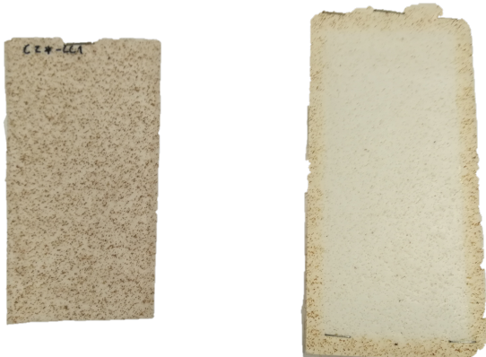
Figura A.1.17 - Controlo C2*-LC1 antes e após o ensaio de solidez à luz.
