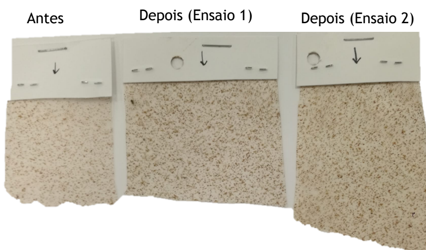
Figura A.4.3 - Resultados obtidos do ensaio de envelhecimento térmico para o controlo C2*.
