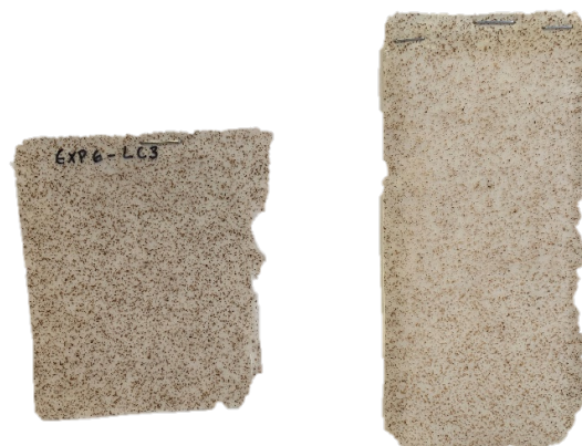
Figura A.1.54 - Amostra com uma fração mássica de hematite de 0,5 % e laca segundo a combinação LC3.
