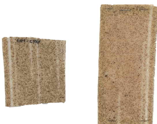
Figura A.4.31 - Amostra com uma fração mássica de hematite de 1 %, pré-skin e laca segundo a combinação LREF.
