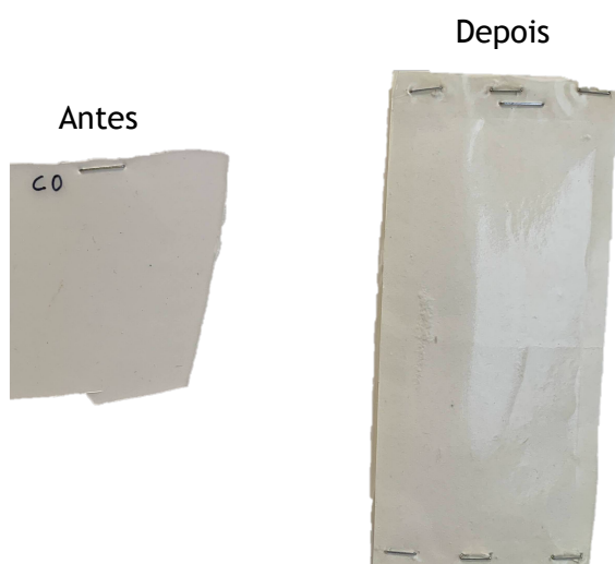
Figura A.1.1 - Controlo C0 (pasta de PVC + pré-skin) antes e após o ensaio de solidez à luz.
