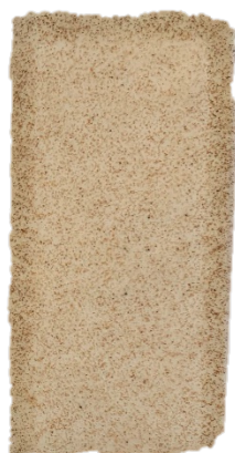
Figura A.1.21 - Amostra com uma fração mássica de hematite de 0,25 %, pré-skin e laca segundo a combinação LREF.
