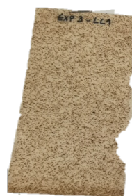
Figura A.1.22 - Amostra com uma fração mássica de hematite de 0,25 %, pré-skin e laca segundo a combinação LC1.
