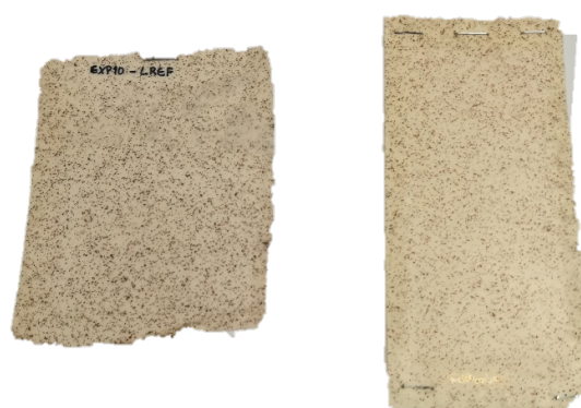
Figura A.1.66 - Amostra com uma fração mássica de hematite de 2 % e laca segundo a combinação LREF.
