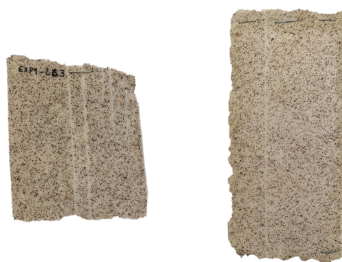
Figura A.1.34 - Amostra com uma fração mássica de hematite de 1 %, pré-skin e laca segundo a combinação LC3.
