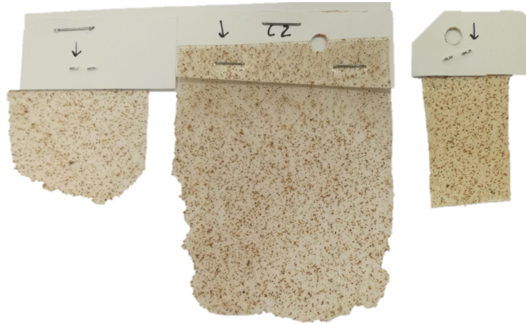
Figura A.4.4 - Resultados obtidos do ensaio de envelhecimento térmico para o controlo C2.
