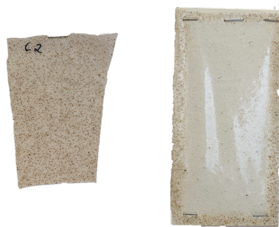
Figura A.1.10 - Controlo C2 antes e após o ensaio de solidez à luz.
