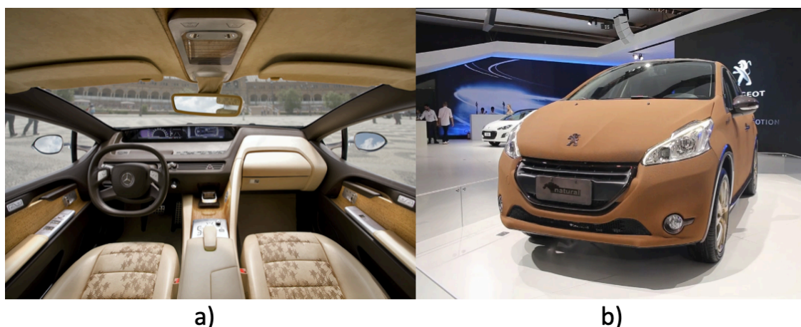
Figura 2.3 - Protótipos de cortiça a) Mercedes (extraída de [20]); b) Peugeot (extraída de [21]).
