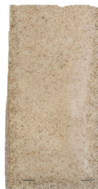
Figura A.1.26 - Amostra com uma fração mássica de hematite de 0,5 %, pré-skin e laca segundo a combinação LREF.
