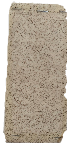
Figura A.1.69 - Amostra com uma fração mássica de hematite de 2 % e laca segundo a combinação LC3.
