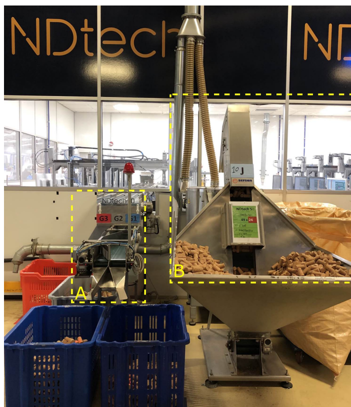
Figura 3.3: Linha de produção NDtech 1.0: Ponto de recolha do produto final (A) e Ponto de abastecimento de rolhas (B).
