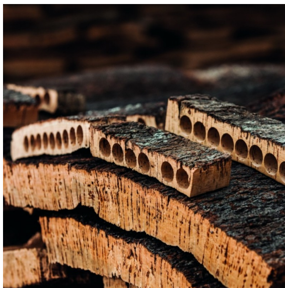
Figura 1.1: Pranchas de cortiça após processo de brocagem (Amorim, 2020).
