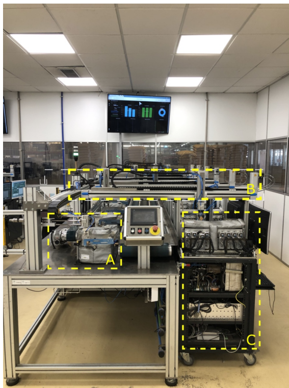
Figura 3.1: Linha de produção NDtech 1.0: Pré-incubador (A), Fecho (B) e Módulo (C).
