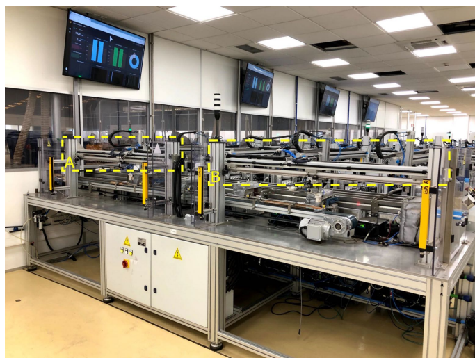
Figura 3.2: Linha de produção NDtech 1.0: Sistema de Alimentação 1 (A) e Sistema de Alimentação 2 (B).
