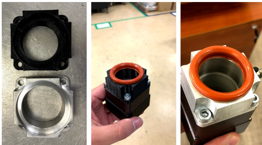
Figura D.2: Desenvolvimento da peça de alteração na câmara híbrida
