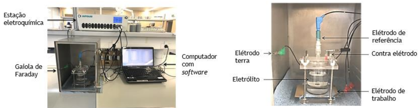
Figura C.1 - Instalação experimental utilizada para os ensaios de imersão.
