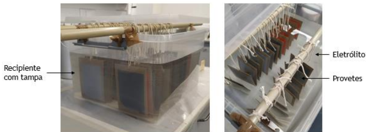
Figura C.1 - Instalação experimental utilizada para os ensaios de imersão.
