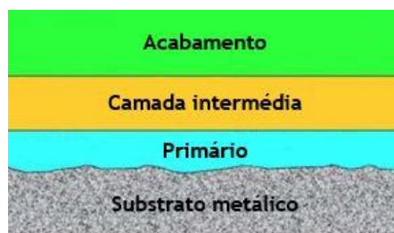
Figura 4 - Esquema de pintura aplicado a um substrato metálico de aço (adaptada de [16]).
