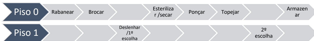
Figura 12 – Síntese do processo produtivo de rolhas naturais
