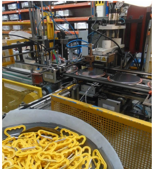
Zona de soldadura da asa
