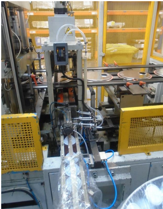
Zona de alimentação e adição de bocais
