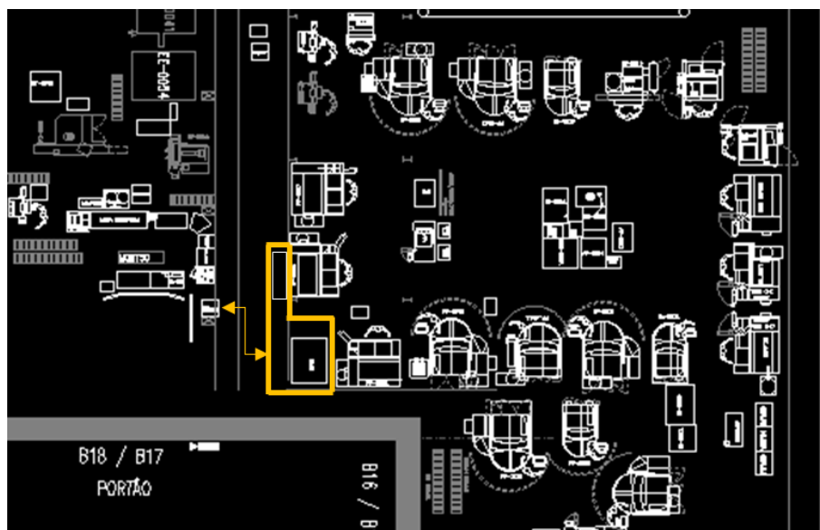
Figura 21 - Introdução da célula de trabalho no layout do chão de fábrica.
