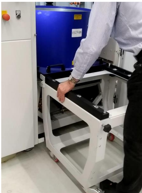
Figura 27 - Troca de mídias com recurso ao trolley designado para o efeito.
