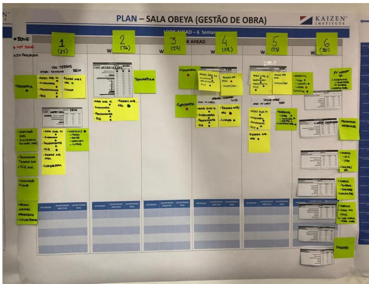
Figura 25 - Planeamento a médio prazo usando o last planner system a seis semanas. Cada atividade é representada por um cartão. Para o horizonte considerado são indicados os requisitos à realização das atividades planeadas e o seu estado de cumprimento. Eventuais constrangimentos que surjam devem entrar num plano de ações para serem solucionados.
