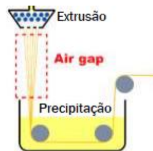
Figura 7. Etapa de dry-jet wet-spinning [9]
