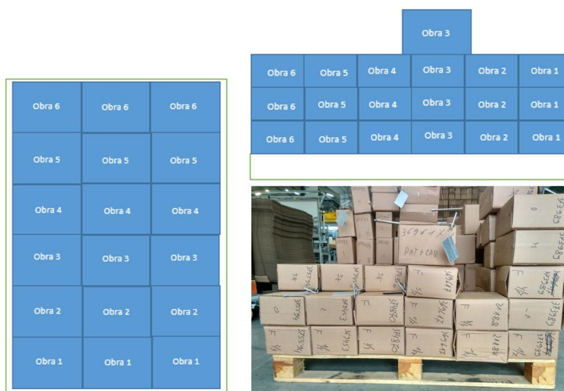
Figura 27- Modo de colocação de caixas de kits de fixações na paleta
