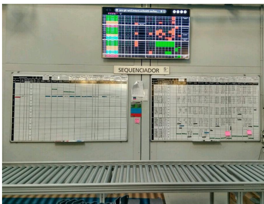
Figura 18- Quadro sequenciador e ecrã digital
