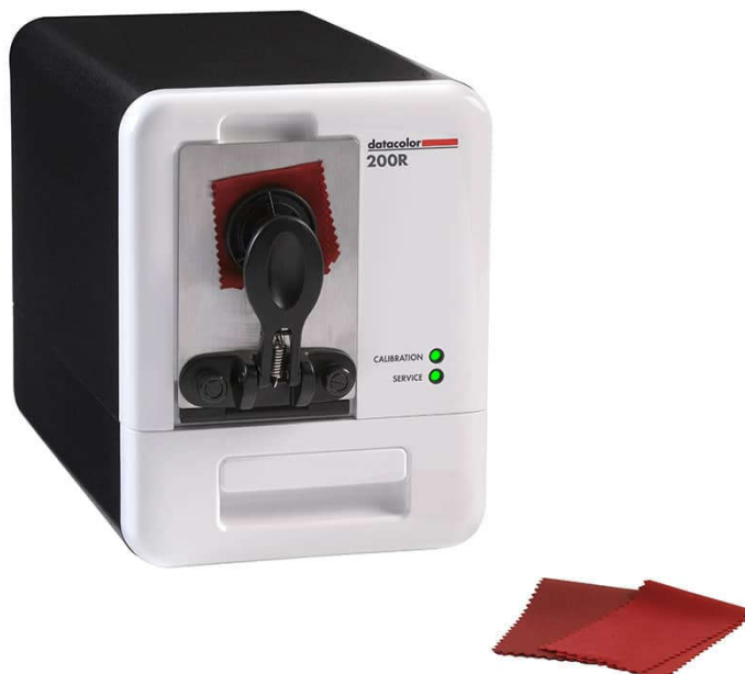
Figura 14 - Colorímetro ou Espectrofotómetro («Datacolor 200 Family Low Cost Spectrophotometer | Datacolor» sem data)
