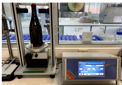
Figura 18 - Afrómetro utilizado para realizar medições de CO_2 .
