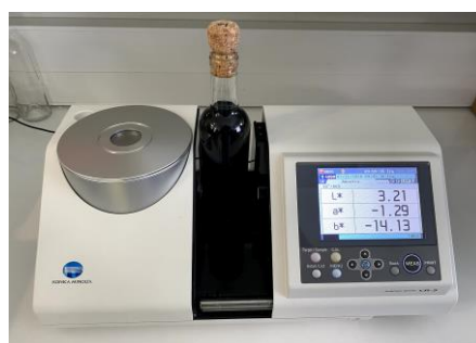
Figura 15 - Colorímetro utilizado para efetuar as medições da luminosidade.
