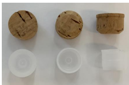
Figura 12 - Bidule de cortiça natural (em cima) e de polietileno (em baixo).
