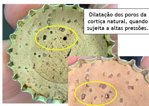
Figura 19 - Dilatação dos poros nas juntas de cortiça natural.
