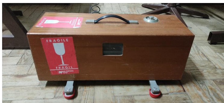
Figura 6.16 – Máquina de impactos normalizada Brüel & Kjær . [fotografia do autor]
