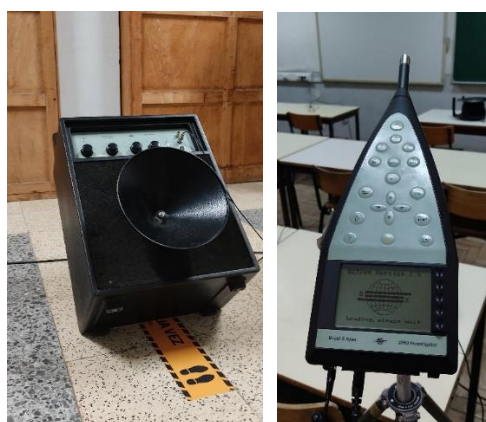
Figura 6.9 e 6.10 - Brüel & Kjær , modelo 4224 e Brüel & Kjær , modelo 2260, usado nas medições. [fotografias do autor]
