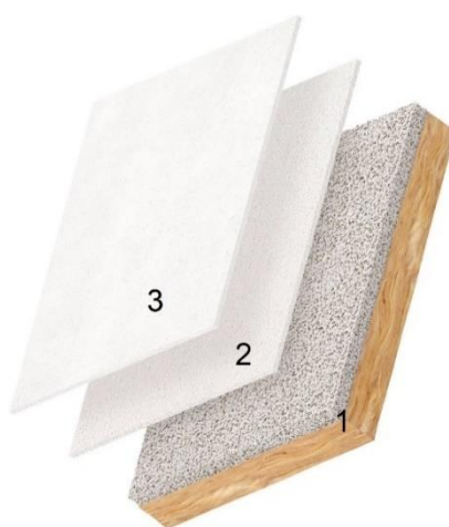
Figura 7.2 – Detalhe das camadas que constituem o BASWAphon . (1 – Camada de suporte, constituída por lã mineral; 2 – Camada de base, é a camada para os acabamentos Fine e Base ; 3 – Segunda camada, ou segunda demão, alisada à mão para um acabamento suave). [97]
