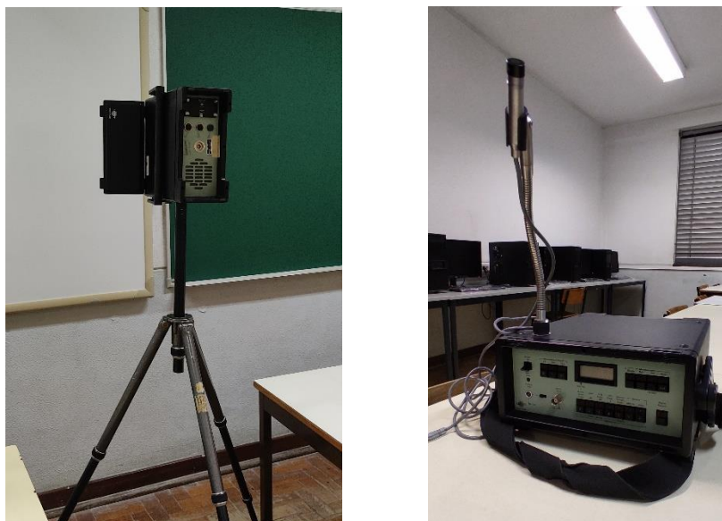
Figura 6.22 e 6.23 – À esquerda, transmissor Brüel & Kjær modelo 4225, e à direita o recetor Brüel & Kjær modelo 4419 para medição de RASTI [fotografias do autor]
