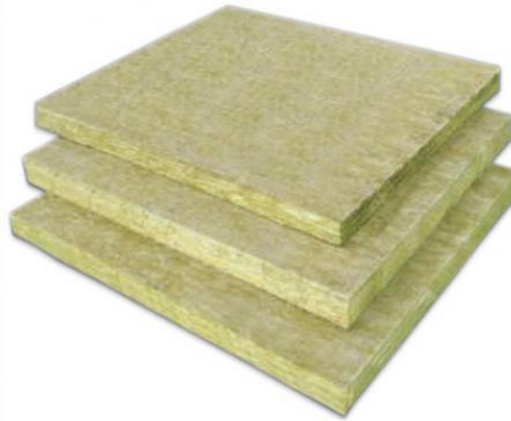
Figura 20 – Manta de lã de rocha [7]
