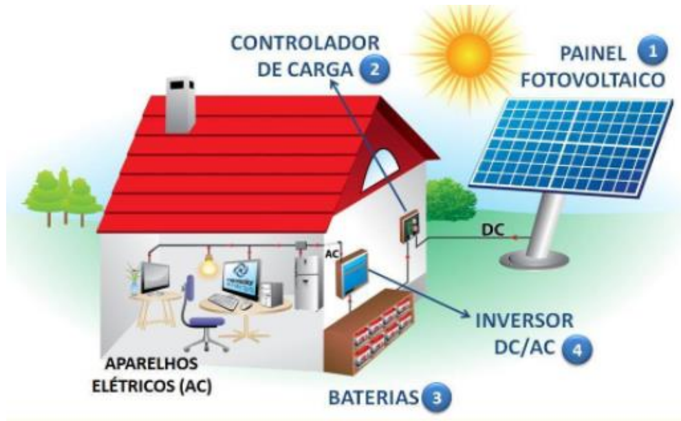
Fig.2.22. - Sistema solar fotovoltaico [44]
