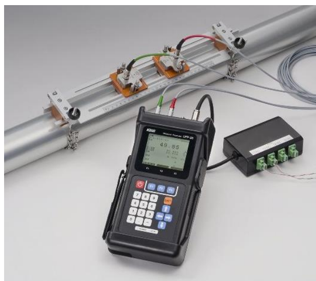
Figura 9 – Caudalímetro ultrassónico para medição de volume utilizado nas auditorias hídricas (Fonte: https://industria.tecnilab.pt )
