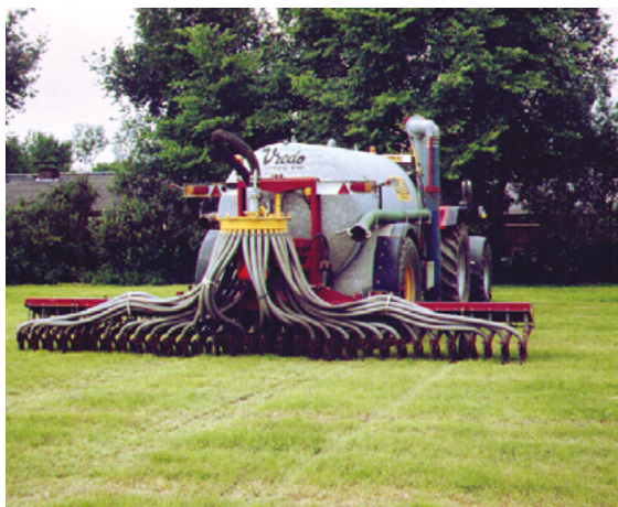
Figura 2. Equipamentos de distribuição de chorume por técnicas de “baixa emissão”: aplicação em bandas (esquerda) e por injeção direta (direita). Estas técnicas permitem reduzir as emissões de \text{NH}_3 a valores muito reduzidos (injeção) ou a valores de cerca de metade (bandas), comparativamente à utilização do prato aspersor convencional.
