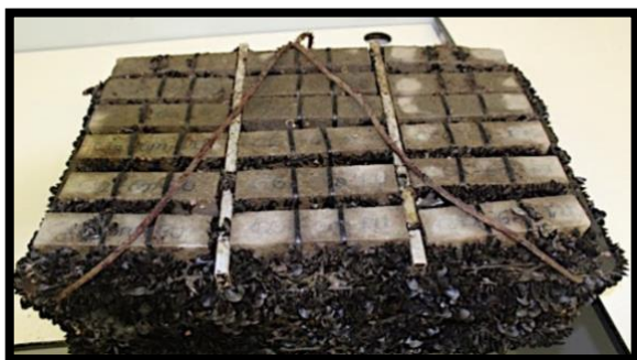
C - Estado da caixa com as amostras prismáticas imediatamente após a retirada do mar e depois de 6 meses de submersão.
