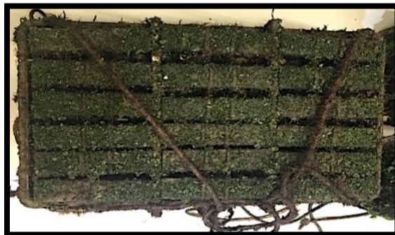
B - Estado da caixa com as amostras prismáticas imediatamente após a retirada do mar e depois de 3 meses de submersão.
